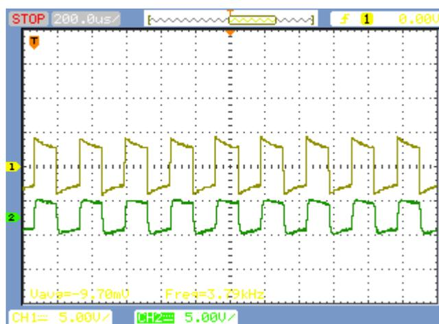
Figura 16 - Formas de ondas gerador de função
