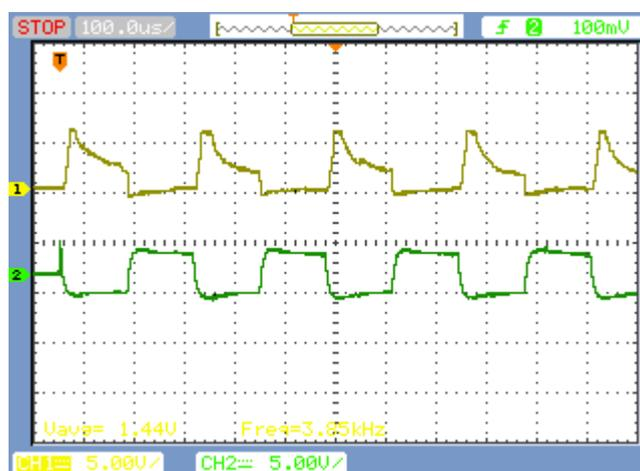
Figura 14 - Forma de ondas para o sensor com os terminais completamente imersos no líquido
