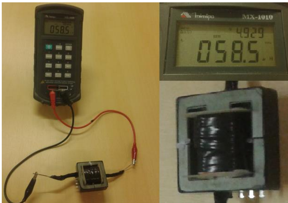
Figura 41 - Foto do indutor Li projetado.
