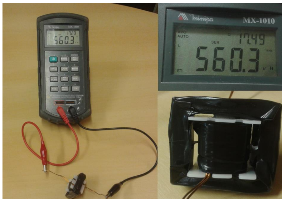
Figura 42 - Foto do indutor L_o projetado.
