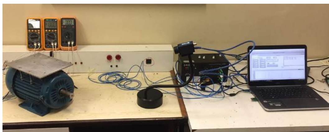
Figura 16: Configuração do ensaio de motor a vazio.
