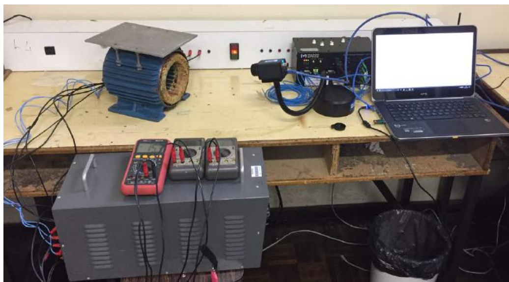
Figura 23: Configuração do ensaio de “rotor travado”.
