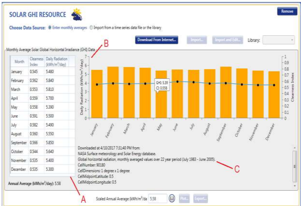
Figura 29: Média mensal de radiação solar na região de Curitiba. Fonte: Adaptado do software Homer Pro (2017).
