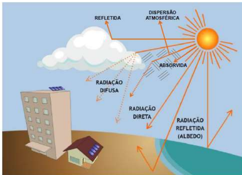
Figura 4 - Componentes da Radiação Solar.
