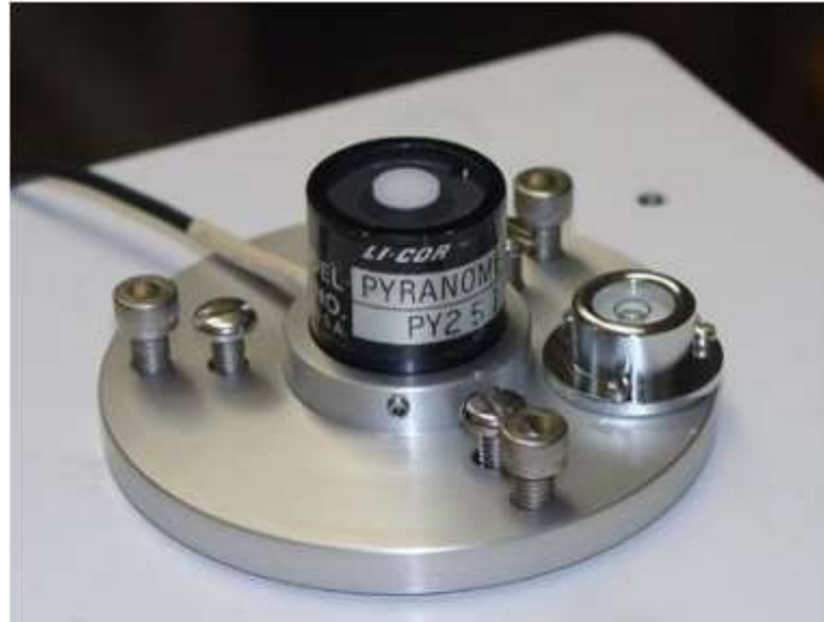
Figura 6 - Piranômetro Fotovoltaico. Fonte: PINHO e GALDINO (2014).
