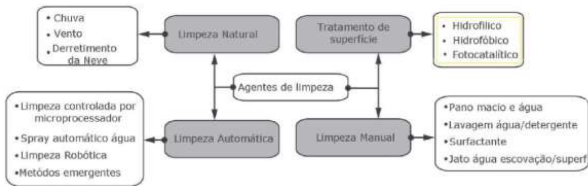
Figura 10 - Agentes de Limpeza de painéis fotovoltaicos.
