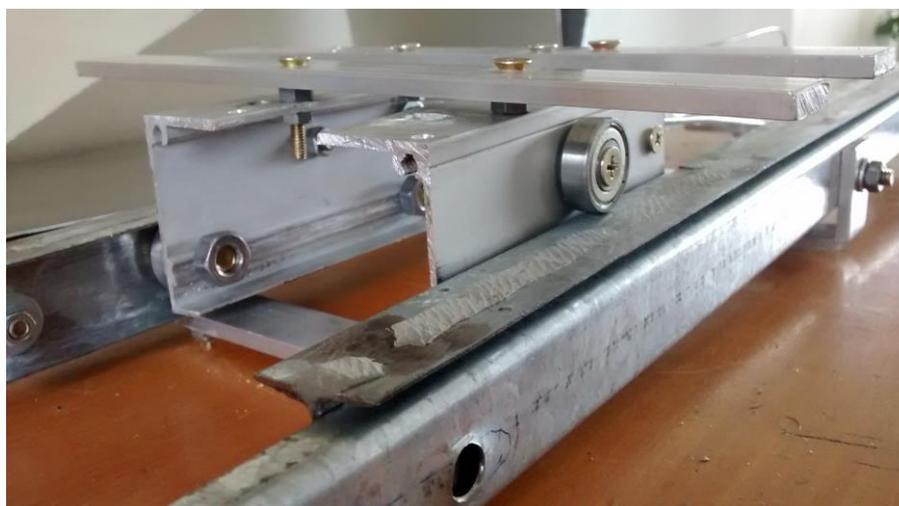
**Figura 10** – Rolamentos internos para elevação de carga
