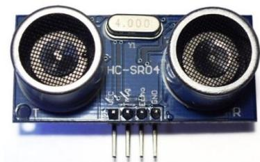
**Figura 24** – Sensor Ultrassônico HC-SR04
