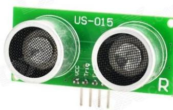
**Figura 26 – Sensor Ultrassônico US-015**
