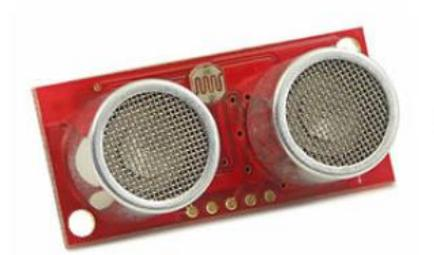
**Figura 22** – Sensor Ultrassônico
