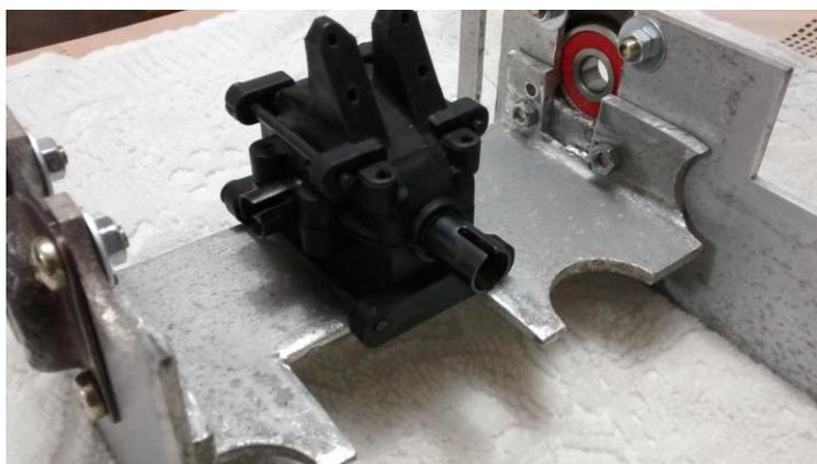
**Figura 15** – Diferencial Automotivo 3:1 no eixo da tração
