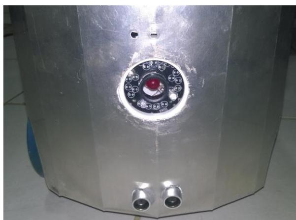
**Figura 42** – Farol de ré acoplado
