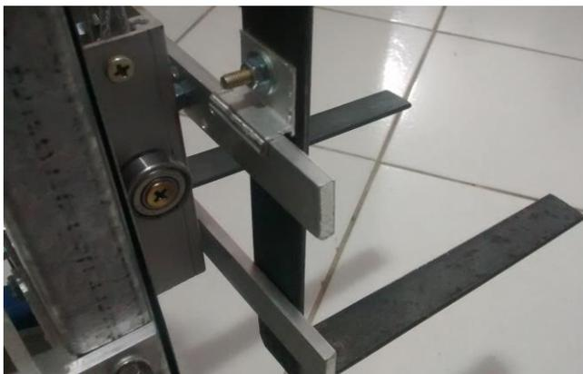
**Figura 46** – Encaixes dos Garfos do *DigiBeetle*
