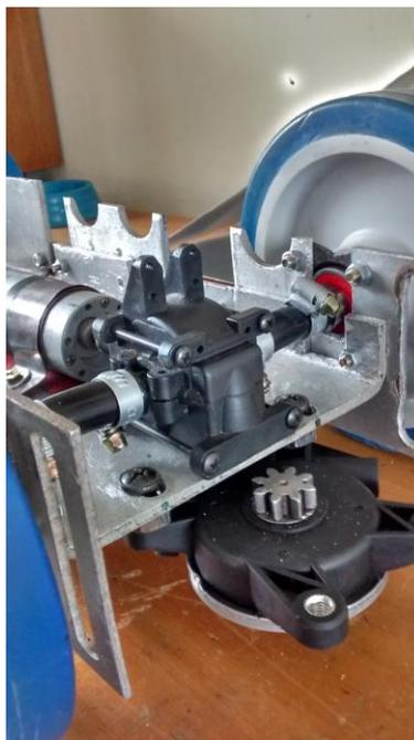
**Figura 27** – Motor CC utilizado em automóveis
