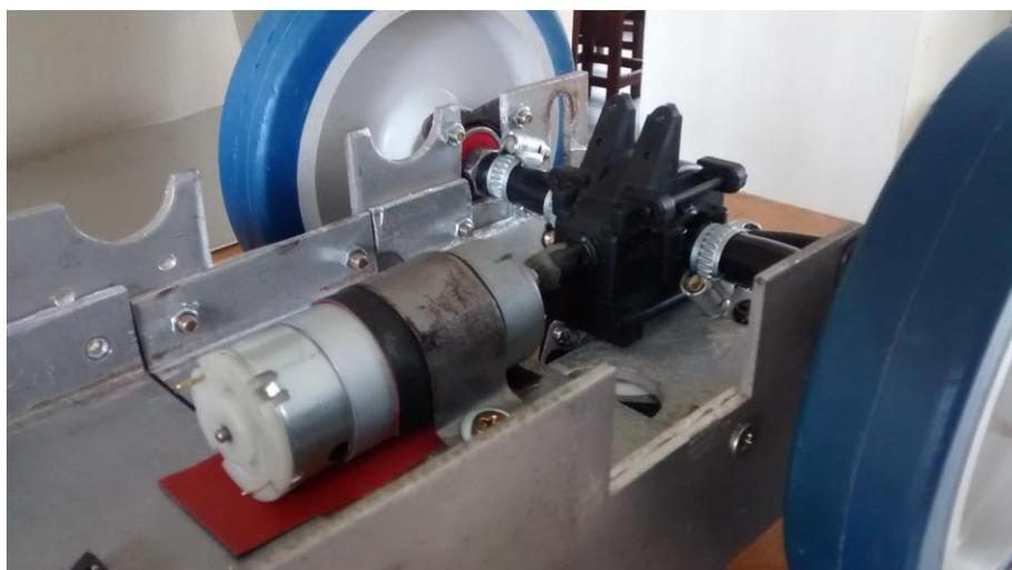
**Figura 17** – Acoplamento do Motor CC ao eixo principal do diferencial
