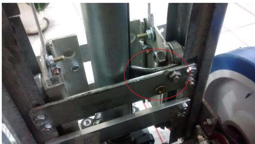
**Figura 13** – Ponto de acoplamento na Torre de elevação
