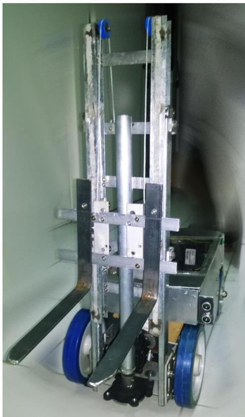
**Figura 12** – Torre de elevação acoplada
