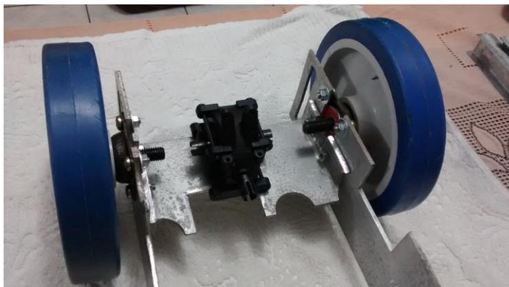
**Figura 16** – Acoplamento do sistema de tração nas rodas dianteiras
