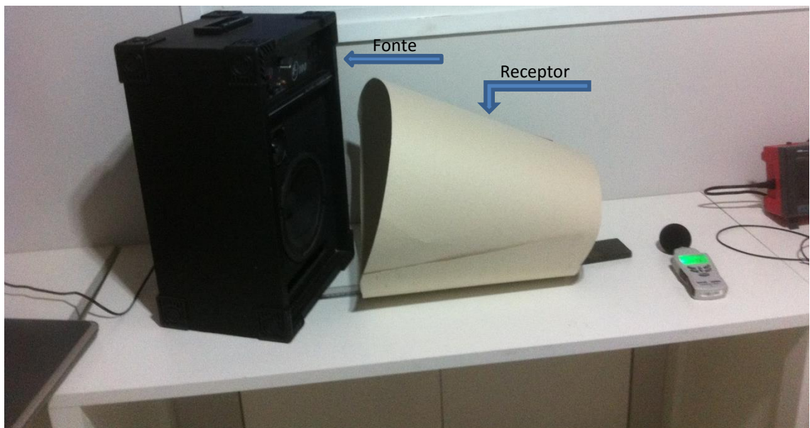
Figura 44 - Setup da conversão de energia sonora para energia elétrica utilizando woofer com corneta.
