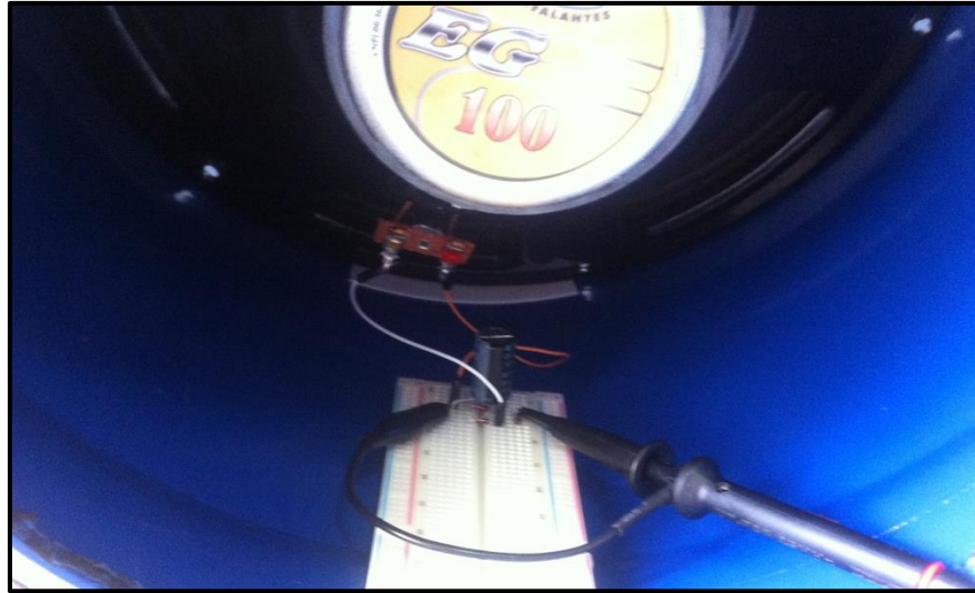
Figura 70 - Conexão dos terminais do alto-falante com o circuito retificador em ponte de onda completa.
