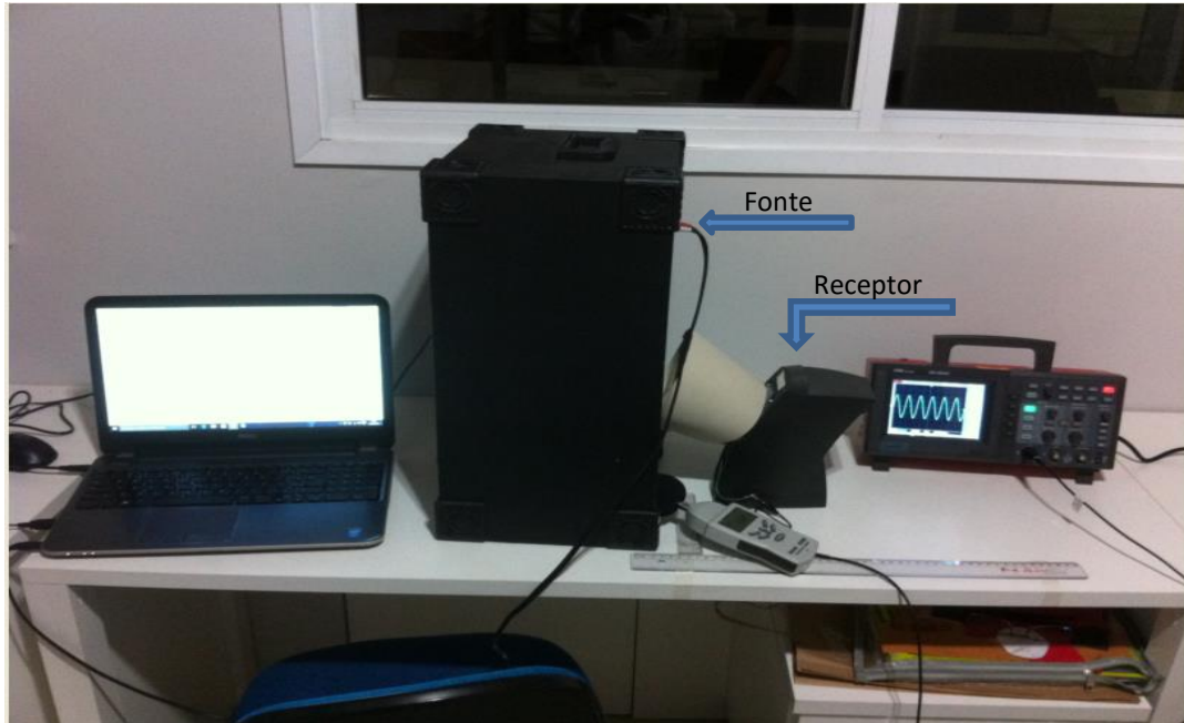
Figura 30 - Setup da conversão de energia sonora para energia elétrica utilizando subwoofer com corneta.
