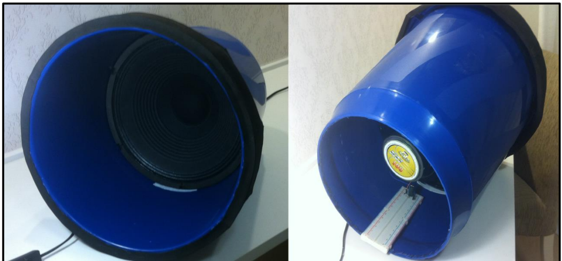
Figura 71 - Protótipo conversor de energia sonora para energia elétrica em corrente contínua.
