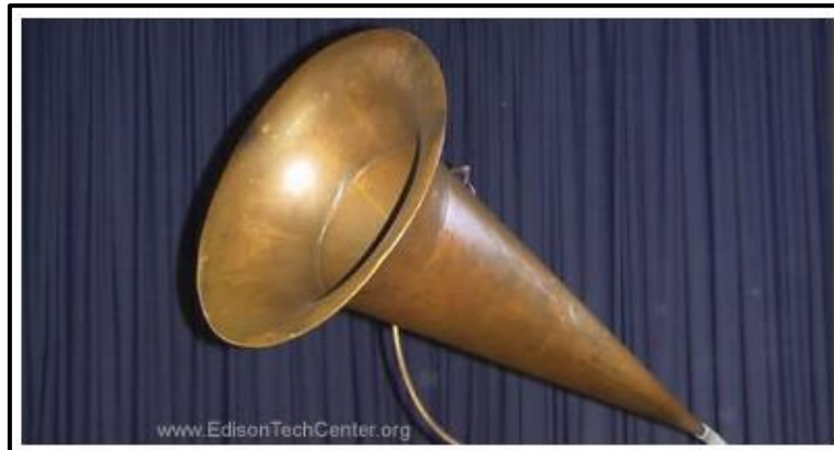
Figura 19 - Corneta usada em fonógrafos e gramofones. Fonte: Edson tech center (2015).
