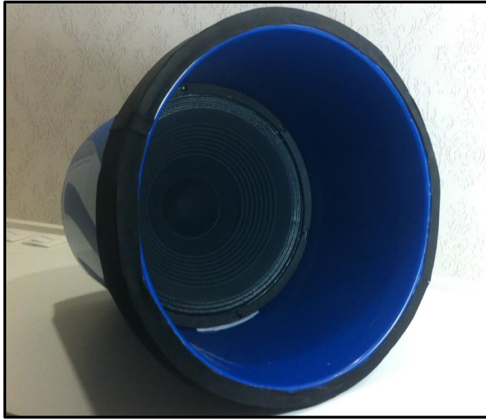
Figura 68 - Corneta de plástico acoplada ao alto-falante woofer.
