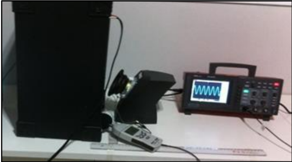
Figura 66 - Transdução da energia sonora em subwoofer sem a utilização de corneta.
