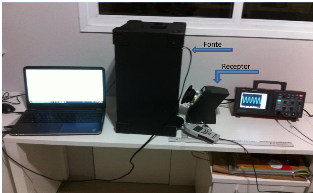
Figura 31 - Setup da conversão de energia sonora para energia elétrica utilizando subwoofer sem corneta.
