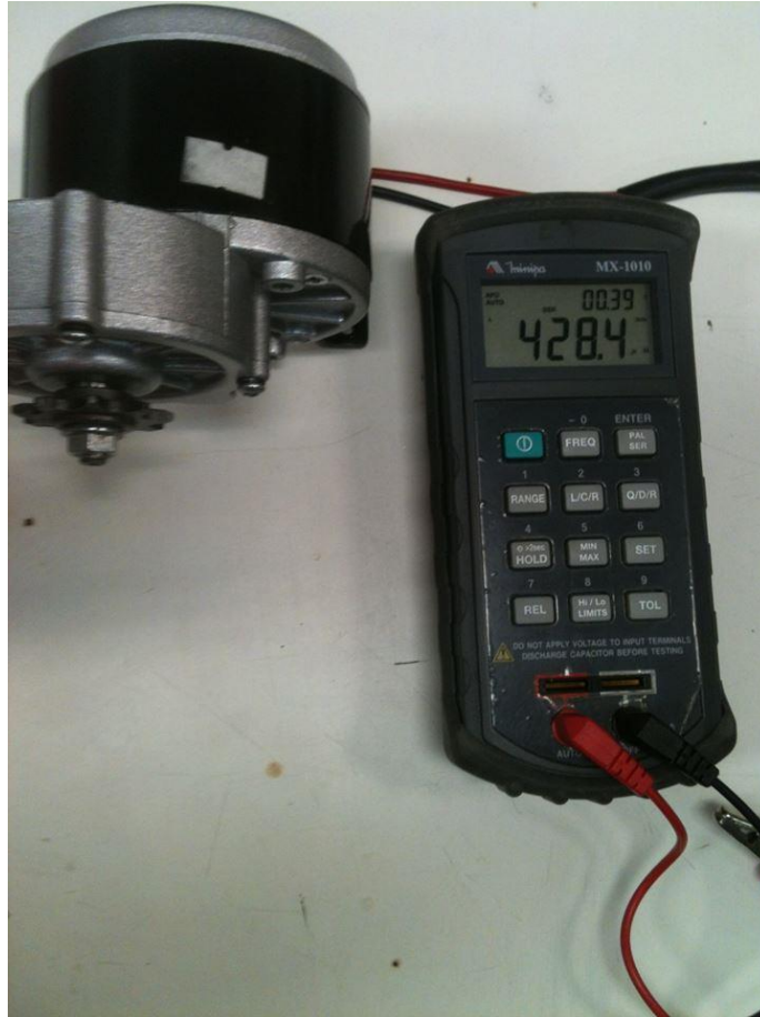
Figura 11: Medição da indutância interna da máquina CC
