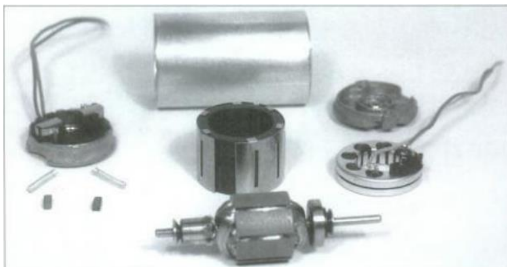
Figura 5: Motor CC de ímã permanente desmontado
