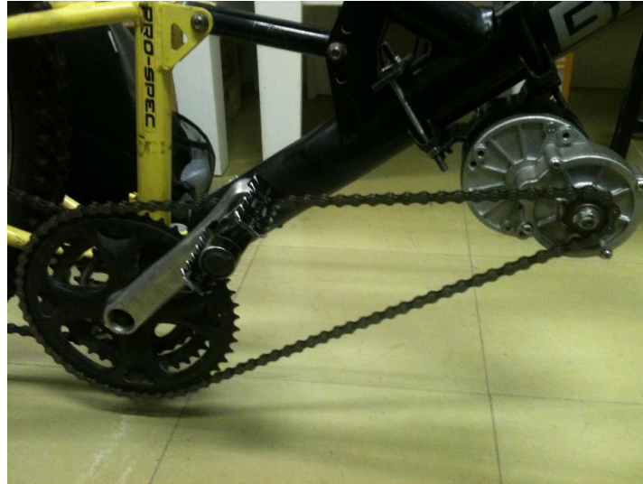
Figura 14: Instalação da máquina CC na bicicleta protótipo
