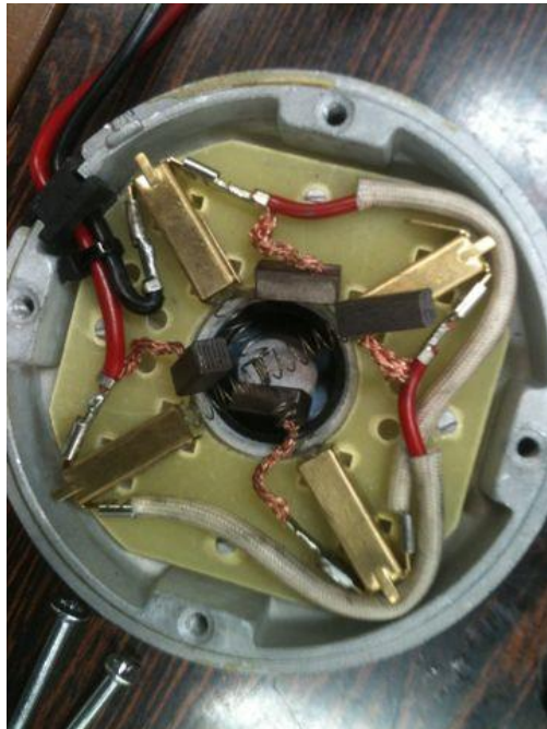
Figura 9: Tampa da parte traseira e escovas do motor
