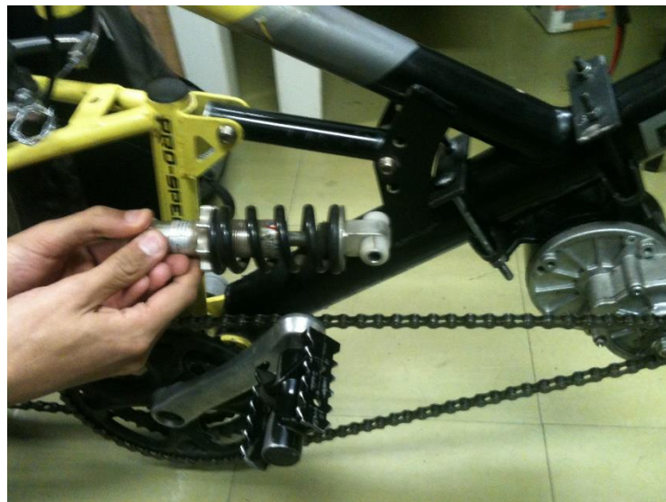
Figura 15: Substituição do amortecedor pela barra fixa
