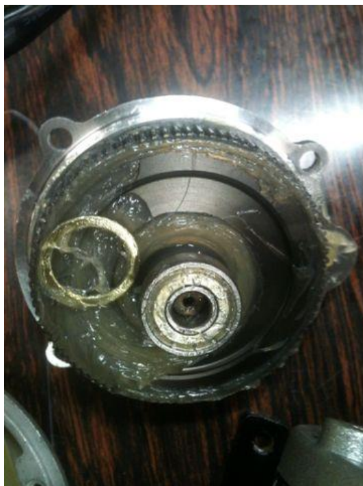
Figura 10: Grupo redutor acoplado do motor CC
