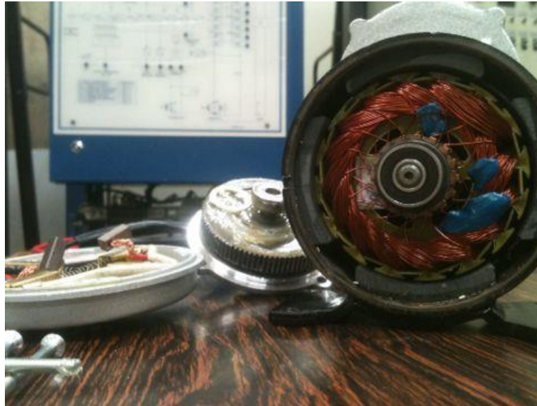
Figura 8: Enrolamentos do rotor e ímãs permanentes no estator da máquina CC
