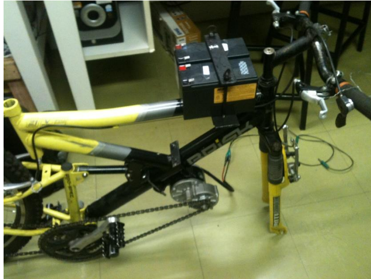
Figura 16: Protótipo da bicicleta com o motor e o suporte para as baterias
