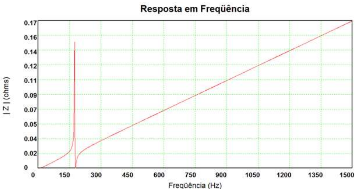
Figura 48 - Resposta em frequência com filtro sintonizado em 180 Hz Fonte: Autoria própria (2016)
