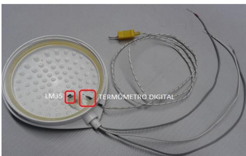
Figura 44 – Sensor LM35 e Termômetro instalados no chuveiro
