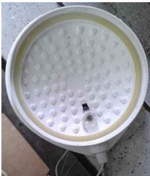
**Figura 33 - Foto do sensor LM35 instalado no chuveiro**
