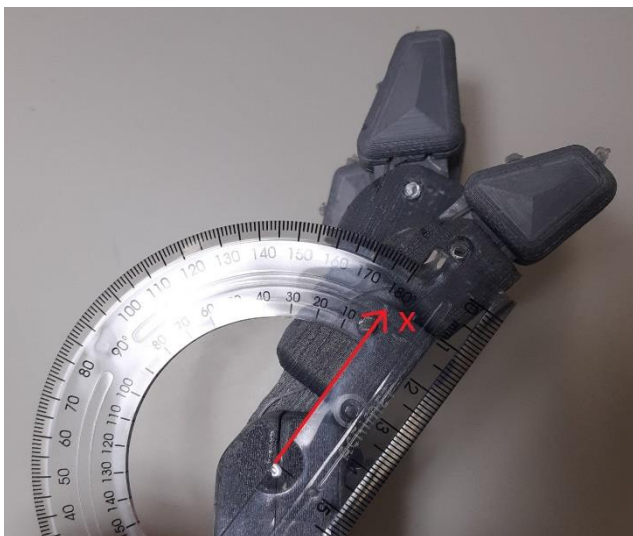
Figura 10 - Indicação da posição inicial do transferidor para mensurar os ângulos de ação. Fonte: O autor, 2018.
