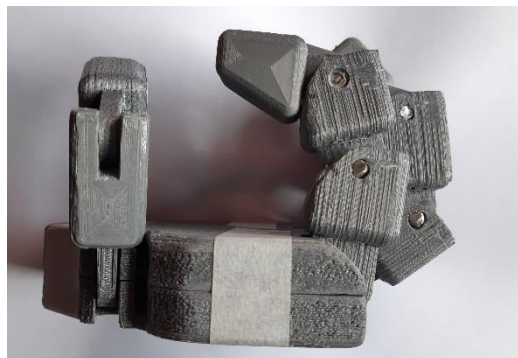
Figura 9 - Detalhe dos eixos da prótese da mão. Fonte: O autor, 2018.
