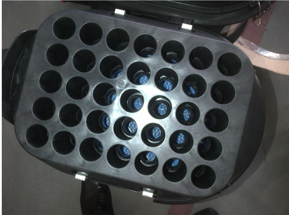
Figura 4.3 - Foto do Pré-filtro que era utilizado na empresa contendo 35 tubos Fonte: Engenharia empresa fabricante de tratores
