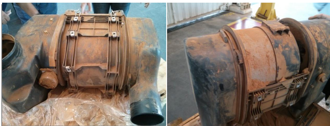
Figura 1.1 - Fotos do conjunto do Filtro de ar nas condições de rápida saturação
