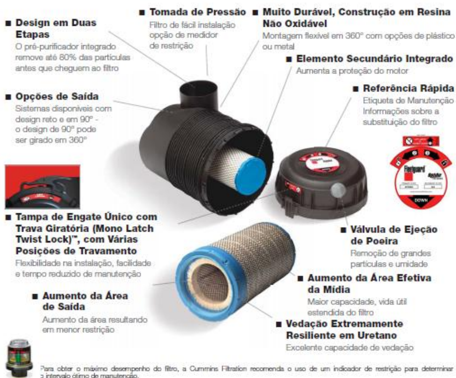
Figura 3.14 - Filtro principal de ar da Cummins e suas as especificações
