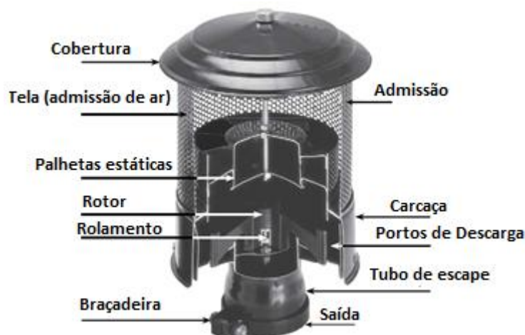
Figura 3.4 - Pré-filtro externo da Parker AFAP414 mostrado em corte esquemático para visualização dos componentes que fazem parte da filtração
