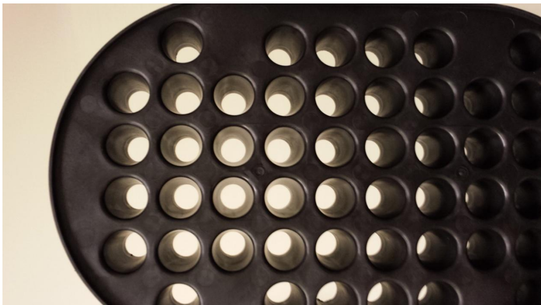
Figura 2.3 - Foto do pré-filtro Donaldson mostrando os Spins / tubos
