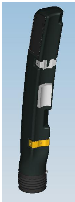
Figura 2.2 - Representação 3D do duto de ar seco / tubo de admissão de ar externo
