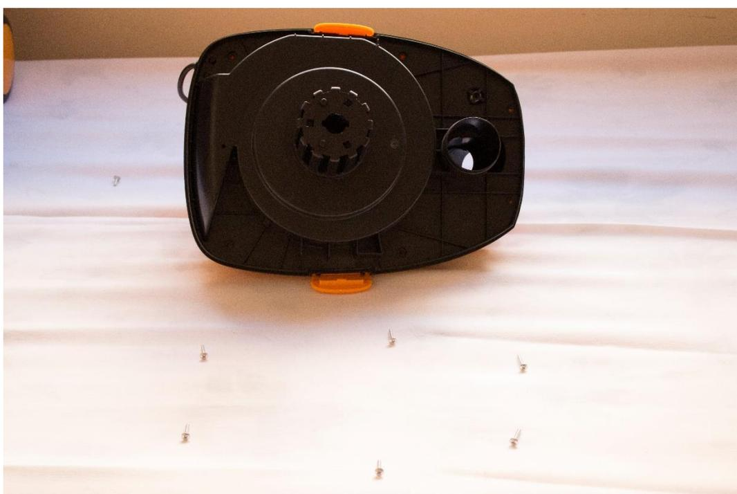
**Figura 21 Desmontagem das peças 2 e 3, parafusos de mesmo comprimento na parte inferior e parafuso de comprimento diferente no lado esquerdo da imagem**
