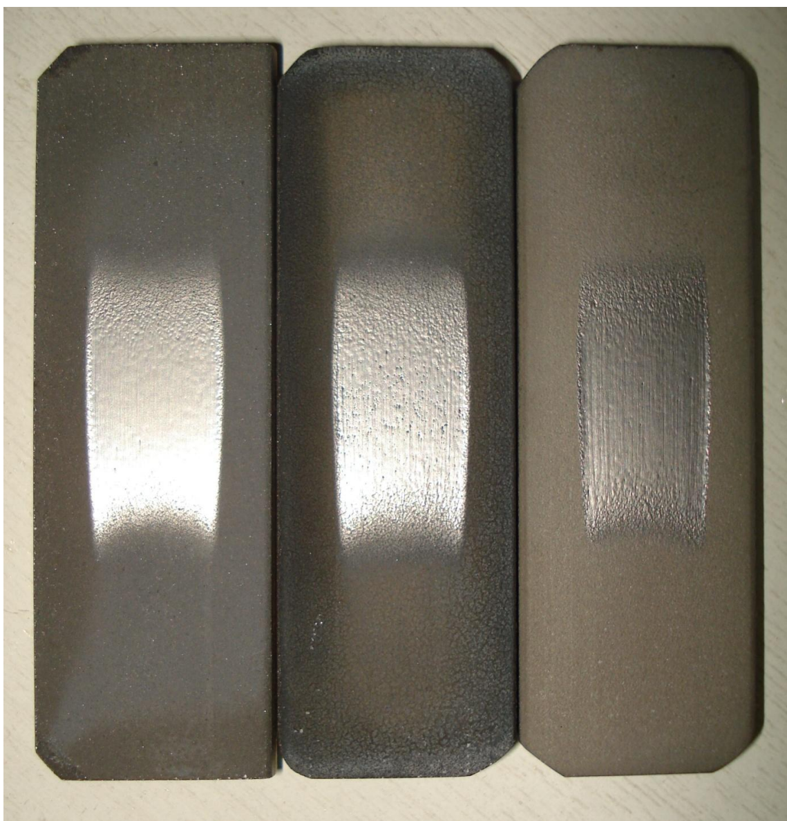
Figura 28 – Amostras desgastadas, tratadas a 700°C, 900°C e 1050°C (da esquerda para a direita)
