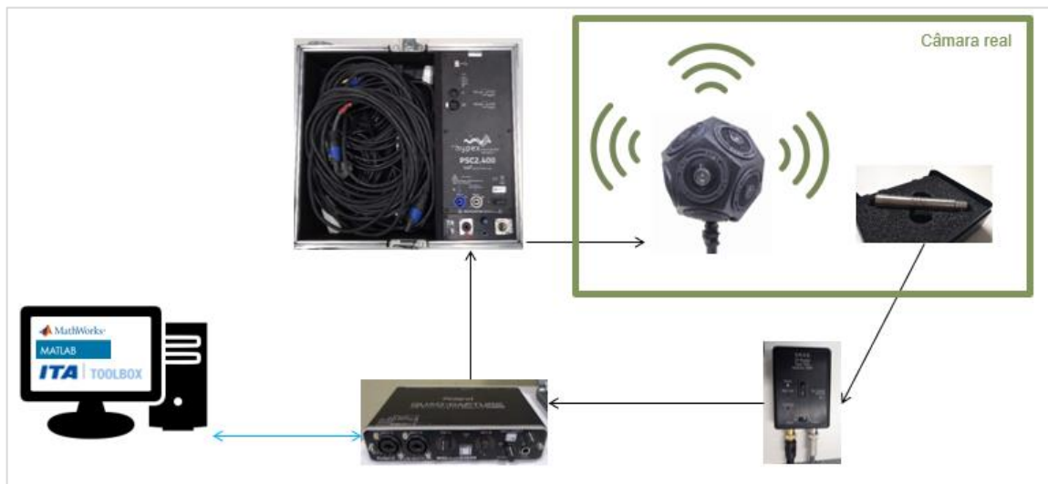
Figura 10 - Esquema da cadeia de sinais utilizada para medições em câmara real
