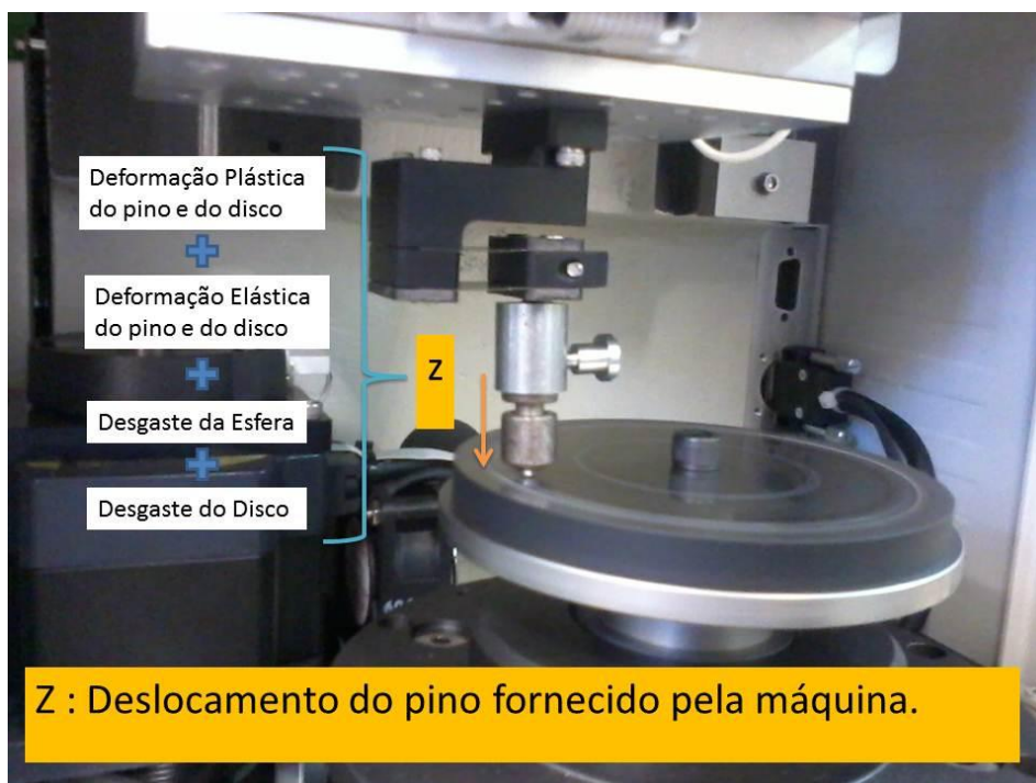
Figura 32 - Justificativa para medição dos diâmetros de desgaste da das esferas.
