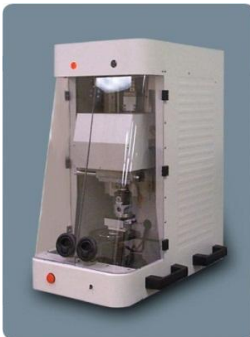
Figura 16 - Tribômetro a ser utilizado nos ensaios em laboratório
