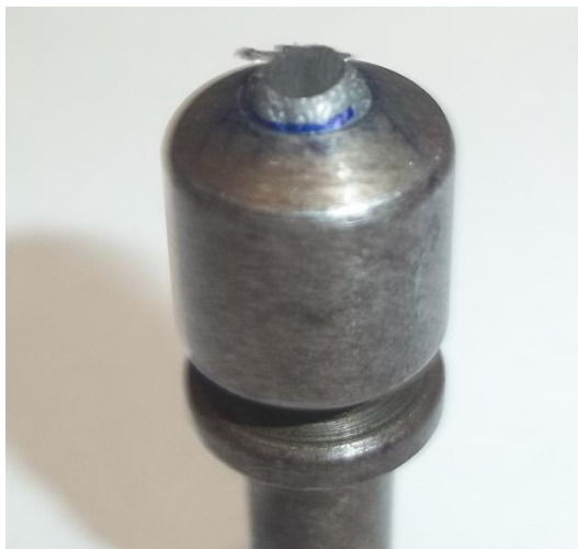
Figura 30 - Evidência do diâmetro de desgaste em uma esfera após ensaio.
