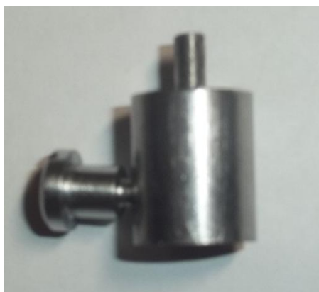
Figura 21 - Peça de acoplamento usinada para adaptar encaixe no tribômetro.
