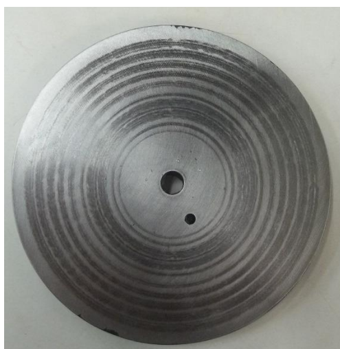
Figura 29 - Face DII f1 após os ensaios de desgaste por deslizamento, evidenciando as pistas marcadas.
