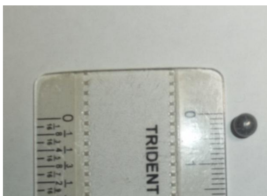
Figura 19 – Amostra de esfera de Alumínio usada nos ensaios.
