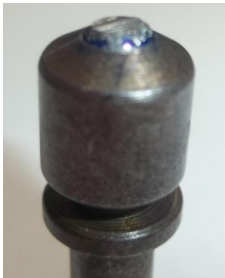
Figura 28 - Esfera após desgaste por deslizamento com distância de 800 m.
