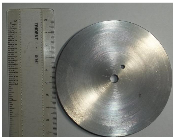
Figura 23 - Disco usinado e pronto para o processo de têmpera .
