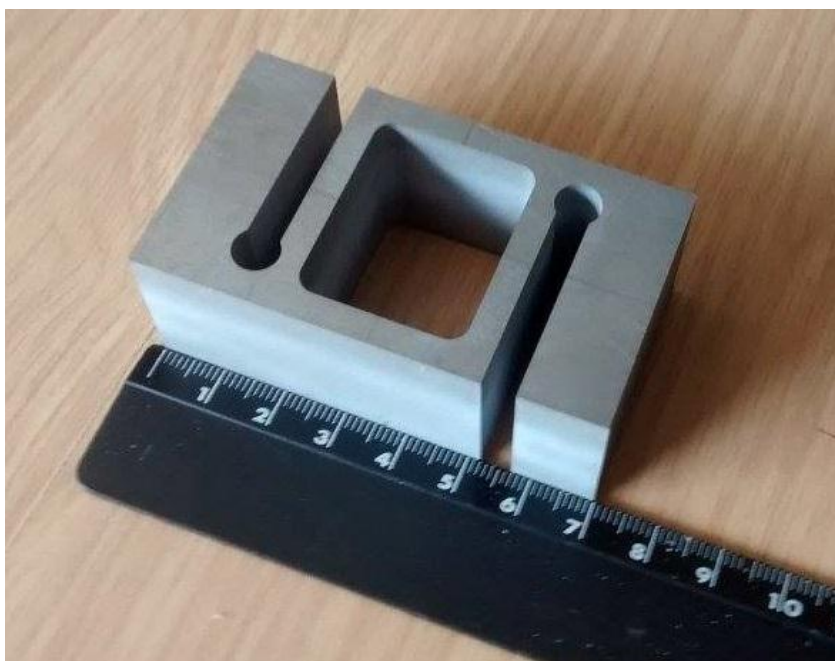
Figura 44 - Eletroerosão da Célula de Carga
