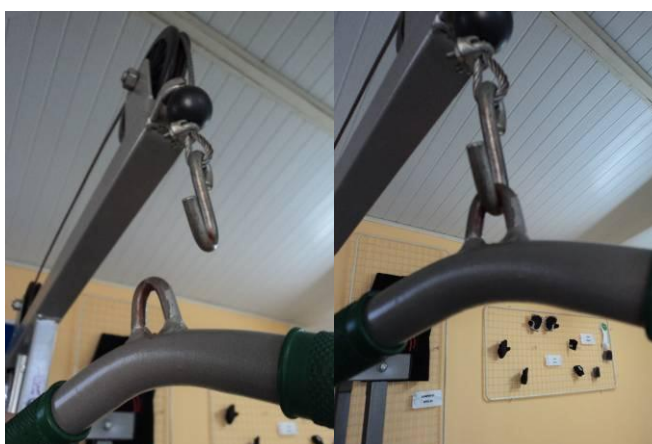
Figura 21 – O gancho da máquina e a barra, montados e desmontados
