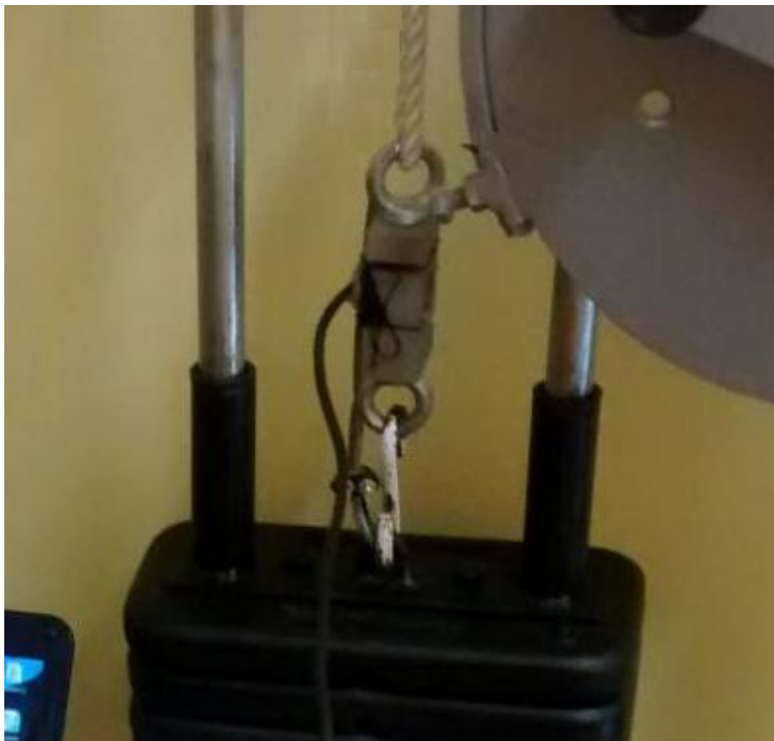
Figura 39 - Montagem para Levantamento da Curva de Transferência
