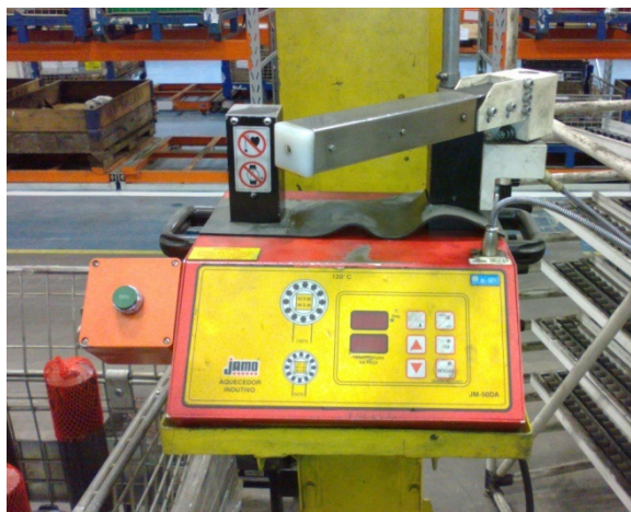
Figura 5 – Equipamento para aquecimento por indução eletromagnética. Fonte: Autoria Própria
