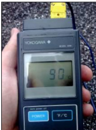
Figura 22 – Termopar medindo a temperatura dos cavacos. Fonte: Autoria Própria.
