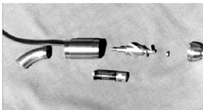
Figura 44 – Protótipo do dispositivo K-Pump desmontado, exibindo sua simplicidade. Fonte: Kubrusly et al. (2000)
