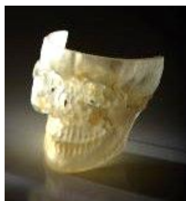
(b) exemplo de protótipo fabricado de FullCure720 ® Transparent .
