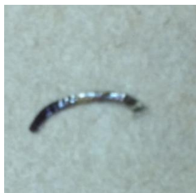
Figura 45 - Cavaco após ensaios de tempo de vida. f = 0,1\text{ mm/rev} e a_p = 0,8\text{ mm} . Fonte: Elaborada pelos autores.
