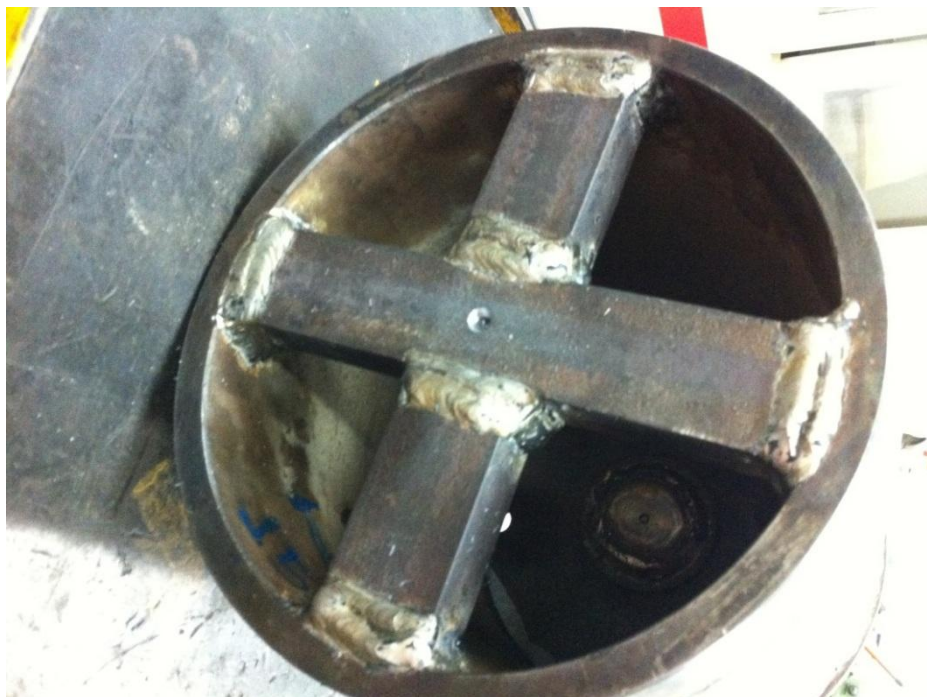
Figura 22 – Barras soldadas para a furação de centro. Fonte: Elaborada pelos autores.
