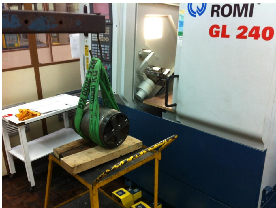
Figura 23 – Uso de cegonha para colocação da peça no torno. Fonte: Elaborada pelos autores.
