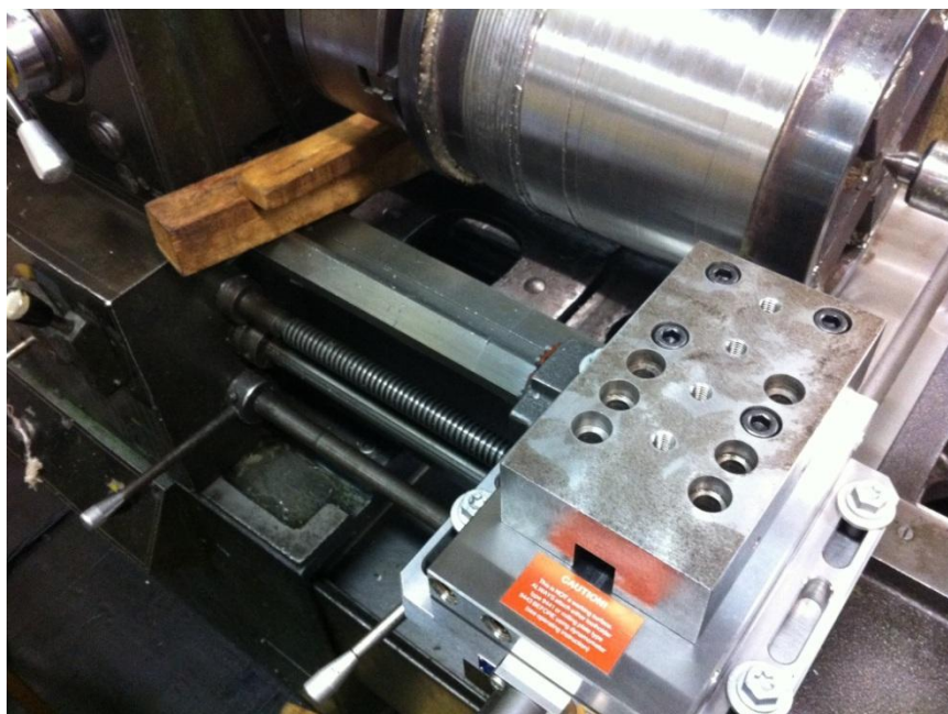
Figura 31 - Dinamômetro e ferramenta montado no torno. Fonte: Elaborada pelos autores.
