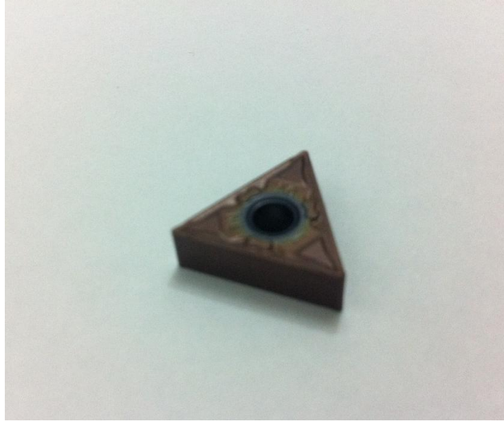
Figura 28 - Foto do Inserto Sandvik Coromant Fonte: Elaborada pelos autores..
