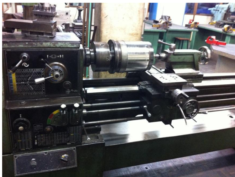
Figura 26 - Torno Romi Imor S-400 II Fonte: Elaborada pelos autores.
