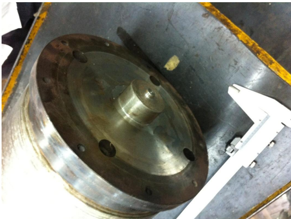
Figura 21 – Tampa e cilindro de aço soldado no tubo API 5L Fonte: Elaborada pelos autores.
