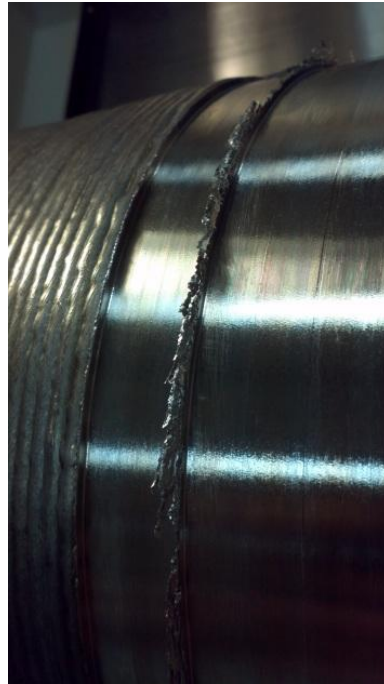
Figura 46 - Serrilhado na peça usinada. Fonte: Elaborada pelos autores.
