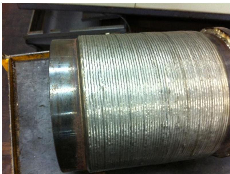
Figura 20 – Tubo API 5L com deposição de Inconel 625. Fonte: Elaborada pelos autores.
