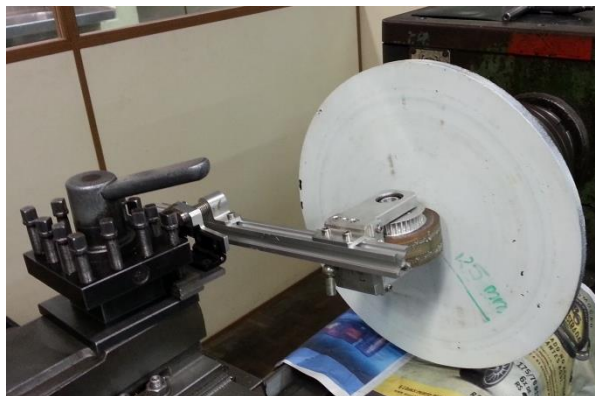
Figura 31 – Teste de desgaste da cobertura da roda em rotação no próprio eixo
