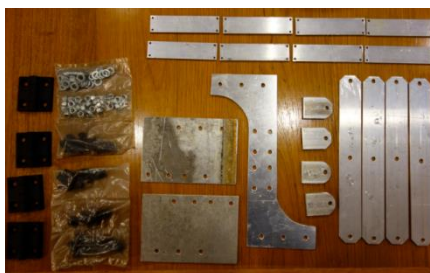
Figura 68 – Furação e acabamento dos componentes para montagem
