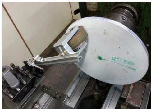
Figura 29 – Teste de desgaste da cobertura da roda em deslocamento curvilíneo
