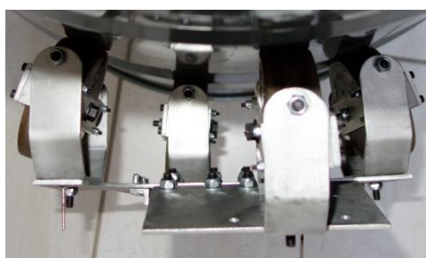
Figura 70 – Acomodação do ângulo de cambagem e suspensão do protótipo
