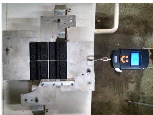
Figura 74 – Teste de capacidade de carga (Ract)
