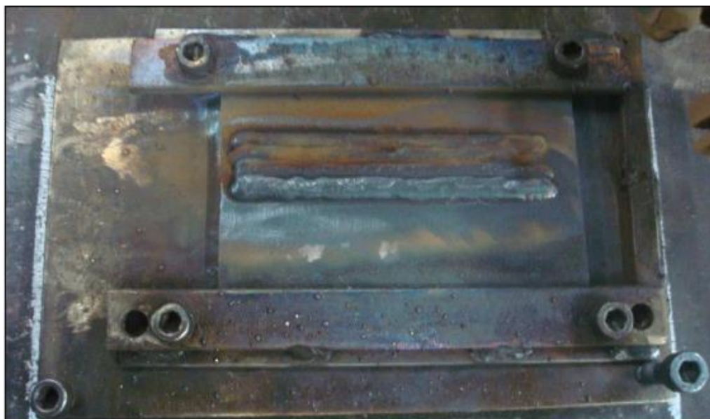
Figura 13 - Gabarito utilizado para fixação das amostras.
