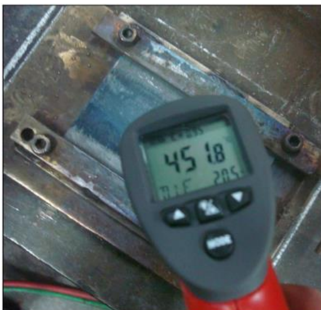
Figura 12 - Medição da temperatura de pré-aquecimento. Fonte: (Ishi, 2012)
