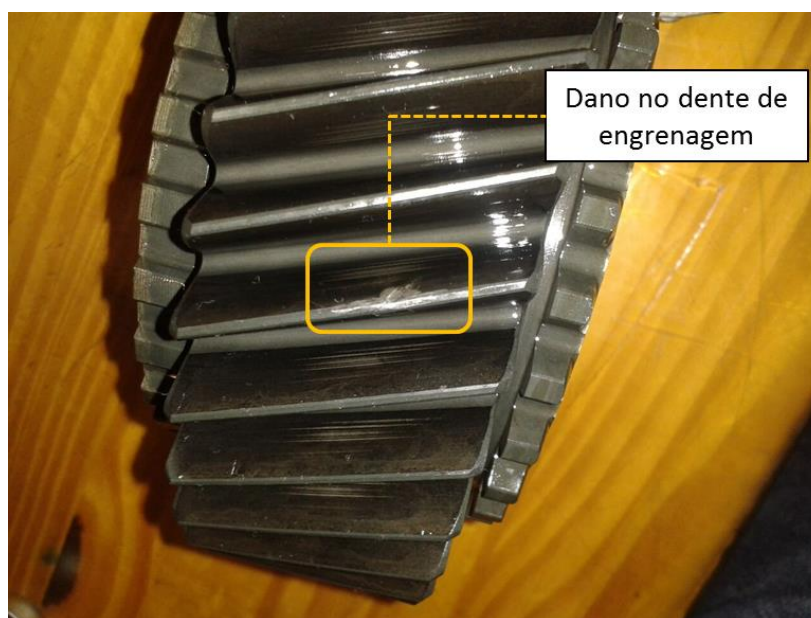
Figura 16 – Dano no dente de engrenagem
