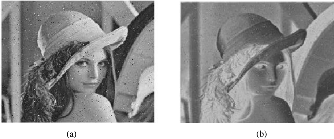
Figura 2.21 – (a) Imagem original corrompida com ruído tipo sal e pimenta; (b) Imagem recuperada utilizando um filtro passa alta
