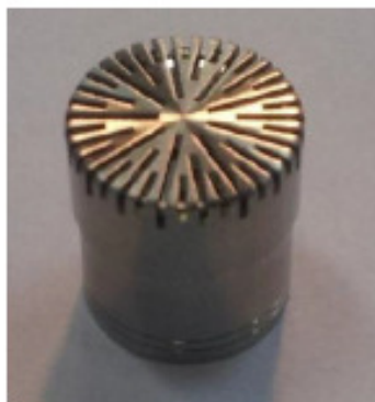
Figura 15 – Microfone condensador capacitivo MCE 212 de 1/2" da marca 01dB.
