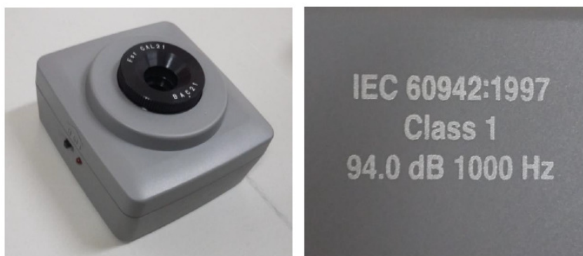
Figura 12 – O calibrador é o Cal 21 tipo I da marca 0dB.
