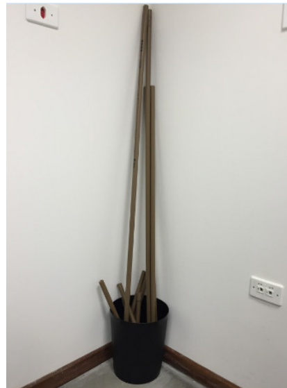
Figura 5 – Tubos de pvc utilizados na construção das arestas da superfície de medição.
