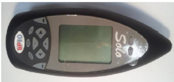
Figura 16 – O medidor integrador SOLO Black tipo I da marca 01dB.
