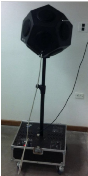
Figura 10 – A fonte de ruído dodecaédrica utilizada é a OMNI 12 da marca 01dB.
