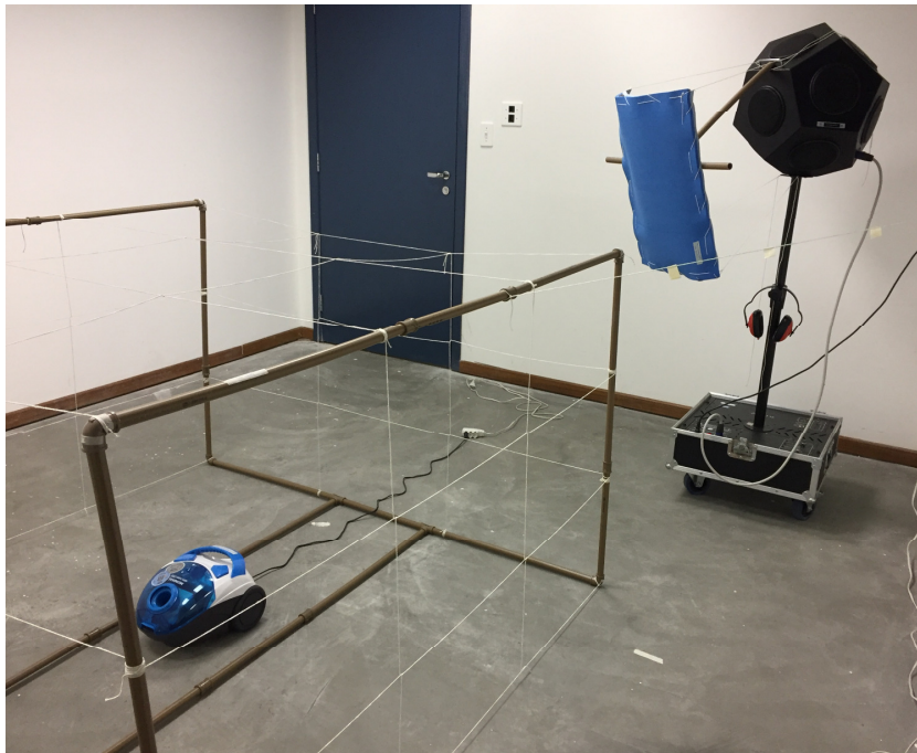
Figura 17 – Aparato utilizado para reduzir a direcionalidade entre a fonte e o aspirador.
