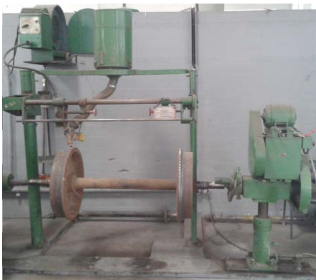
Figura 1 - Máquina de Recuperação de Frisos Ferroviários Fonte: Autoria própria 1
