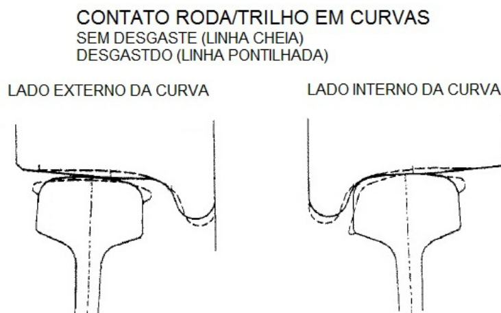
Figura 5 - Contato roda - trilho em curvas Fonte: Adaptado de Cantera, 1993
