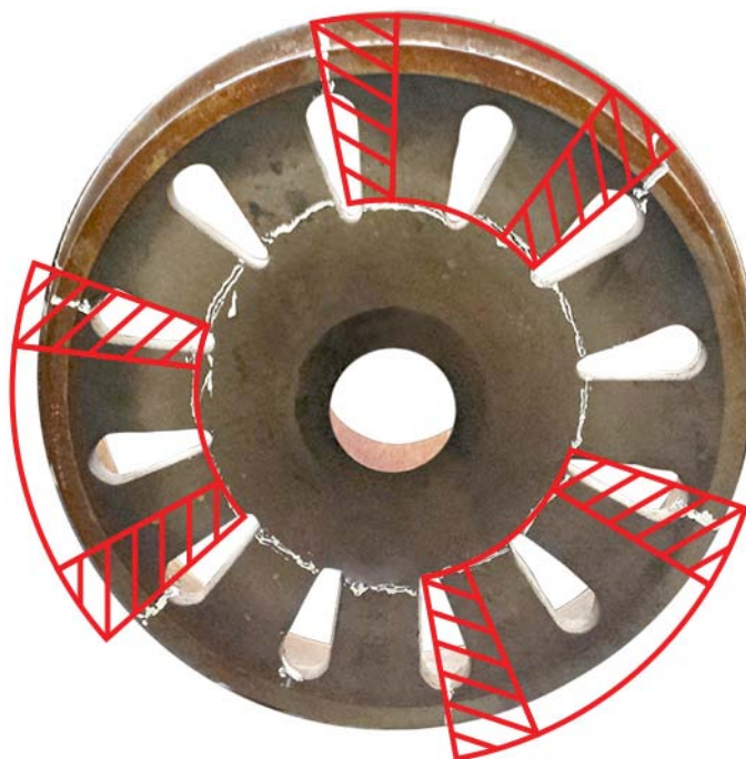
Figura 18 - Região de corte oxi-acetilênico para obtenção de amostras
