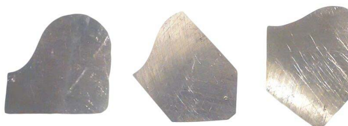
Figura 21- Amostra após a retificação e corte com disco abrasivo
