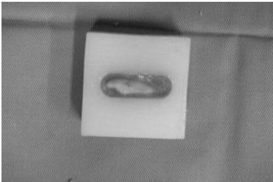
**Figura 11 - Amostra preparada e fixada no molde utilizando-se cera nº 7.**
