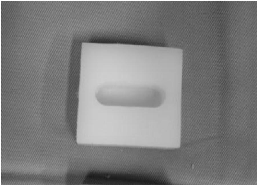
**Figura 10 - Molde em nylon para fixação e acondicionamento dos dentes a serem submetidos aos ensaios de dureza.**
