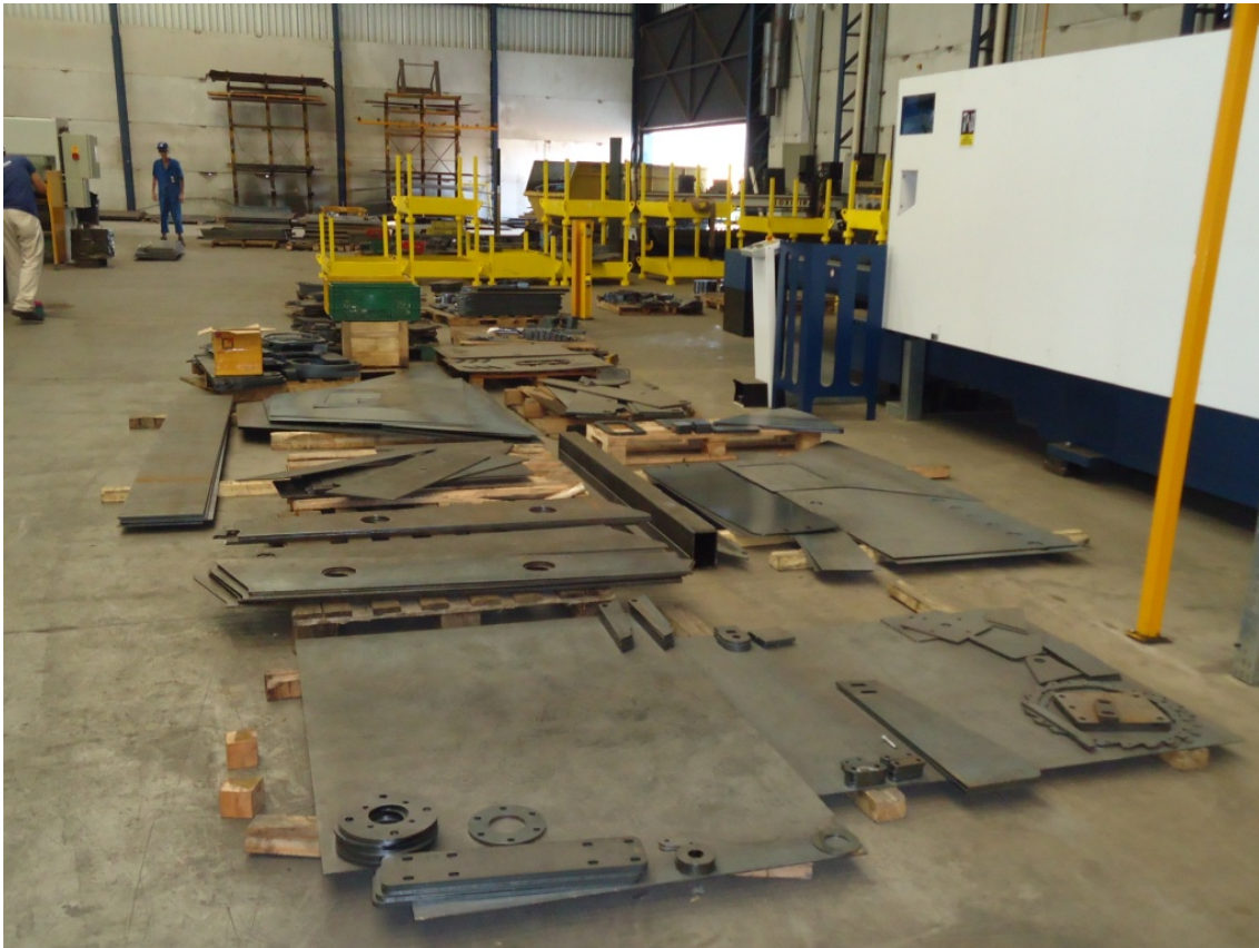
Figura 28 – Chapas de aço cortadas em excesso.
