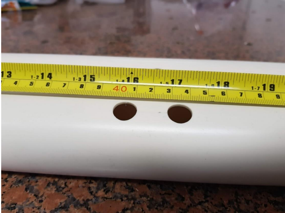
Figura 15 – Furações para comportar o microfone de medição.
