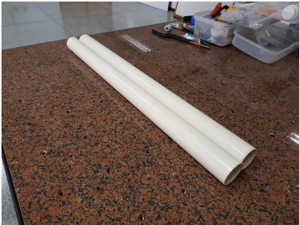
Figura 14 – Tubos de PVC utilizados na montagem do corpo do aparelho.
