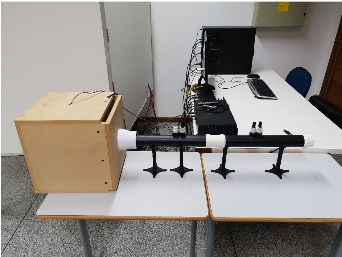
Figura 18 – Montagem completa do tubo.
