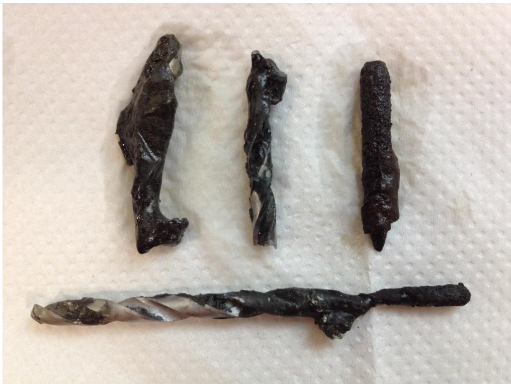
Figura 19 – Broca tratadas recém retiradas do forno, quebradas apenas pelo manuseio. Broca com corrosão na haste, na qual foi inserido somente a área de corte.
