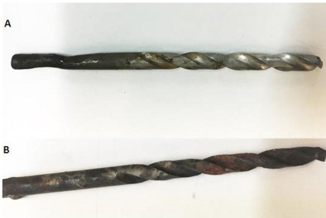
Figura 20–Brocas após limpeza dos resíduos dos banhos de tratamento em aço M2 (a) Boretação, (b) TRD
