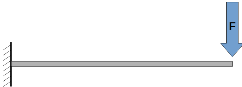
Figura 2.1. Viga delgada carregada Fonte: Autoria própria.
