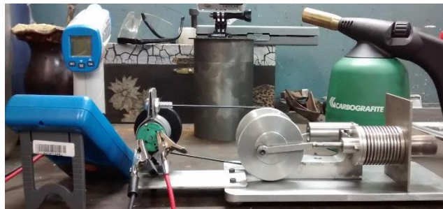
Figura 44: Teste de potência do motor Stirling otimizado.
