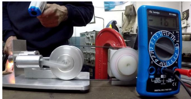
Figura 40: Teste de potência do Motor Stirling.
