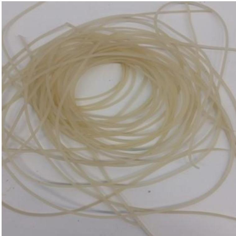
**Figura 16 – Exemplo de monofilamento obtido (AM01)**
