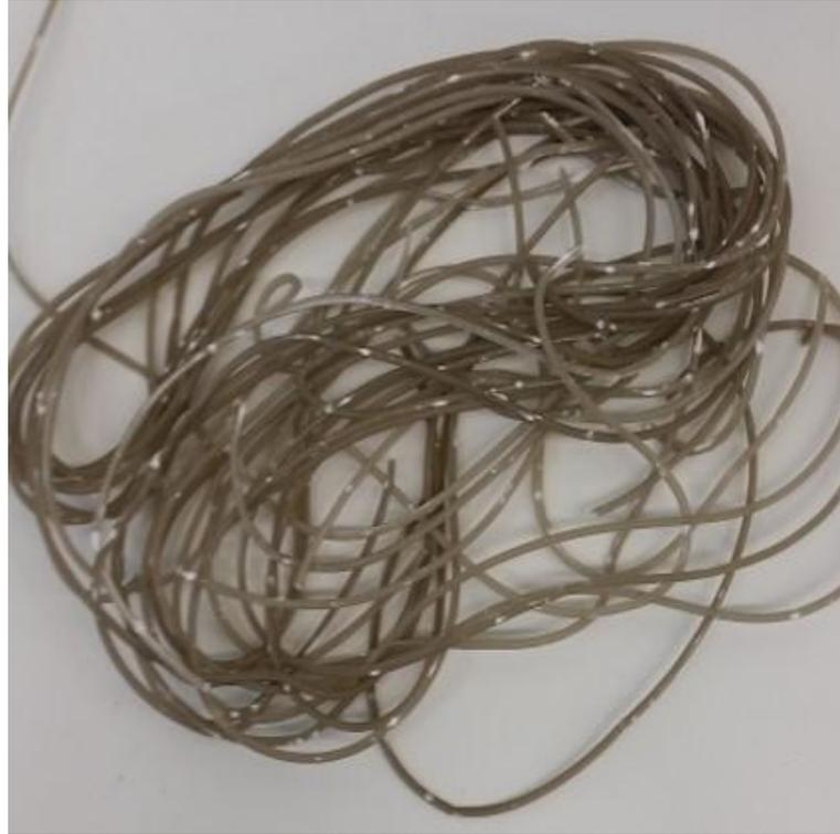
**Figura 14 – Amostra que sofreu decomposição durante processo de extrusão (AM03)**
