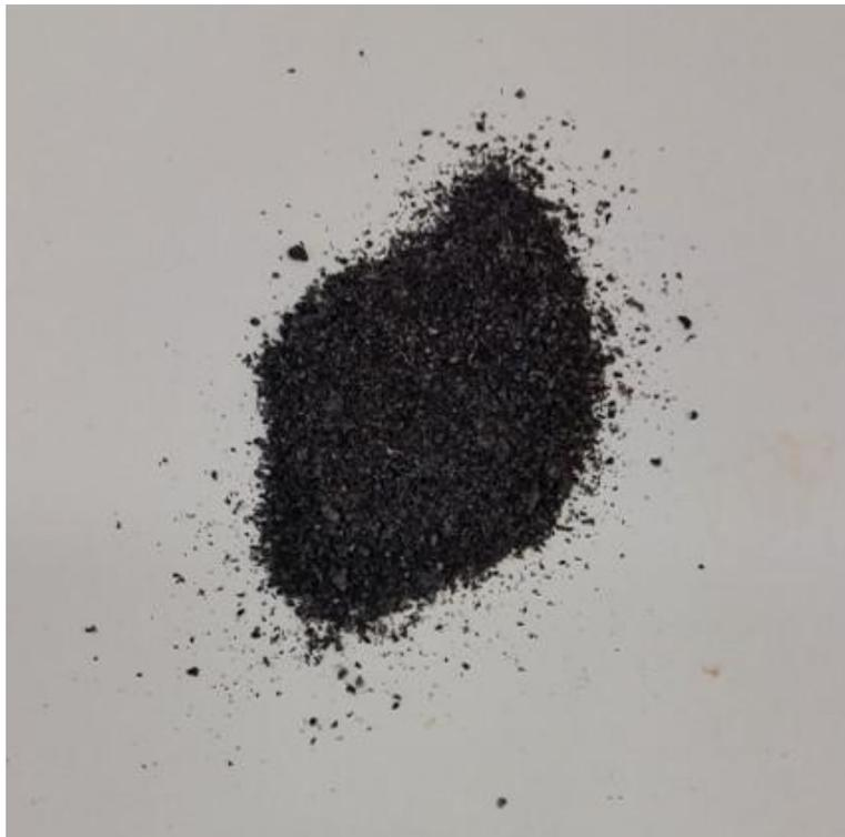
**Figura 21 – Blenda AM03-PE com granulação fina**
