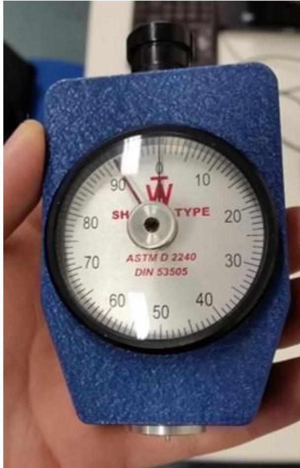
Figura 12 – Durômetro Shore A
