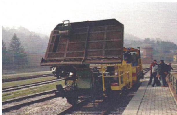
Figura 14 - Máquina de capina por radiação infravermelha. Fonte: (ROSA, 2005, p.62).
