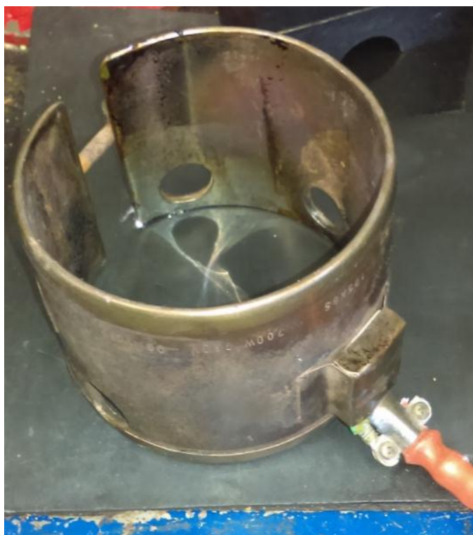
Figura 23 - Resistência de cinta de 700W.
