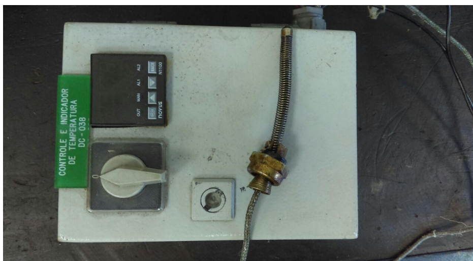
Figura 24 - Controlador PID Novus e sensor PT100.
