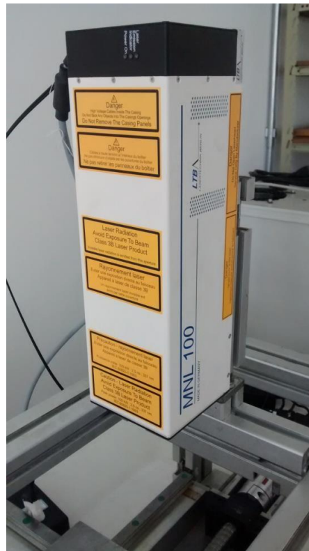
Figura 3.5 - Laser MNL - 100 da Lasertechnik Berlin. Fonte: autoria própria.
