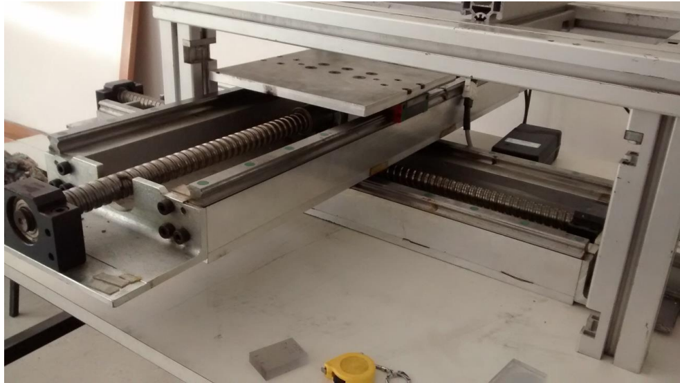
Figura 3.4 - Mesa CNC-XY desenvolvida na UTFPR. Fonte: autoria própria.
