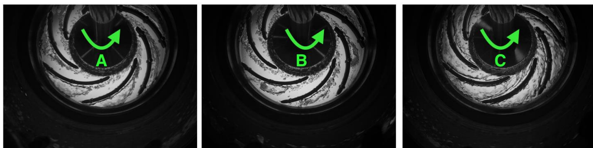
Figura 4.7 - Descontinuidades da Curva de 400 rpm e fração de vazio de 3%.
