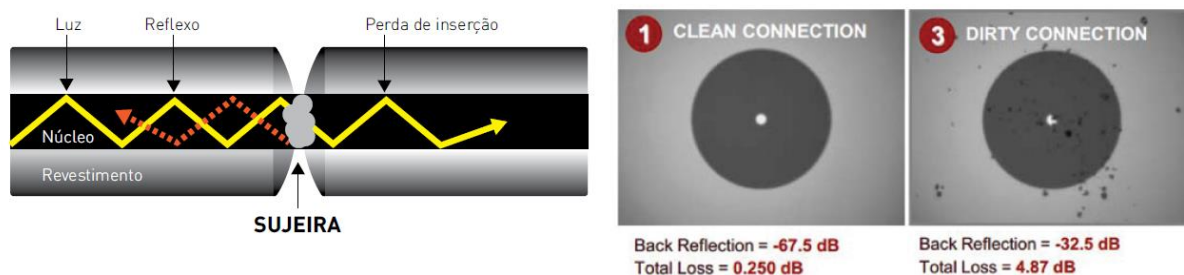
Figura 4 - Perdas de IL e RL devido a sujeira. Fonte: adaptado de Furukawa (2018)
