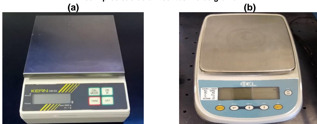
Figura 35 – Tipos de balanças utilizadas: (a) Balança com precisão de uma grama, (b) Balança com precisão de um centésimo de grama.
