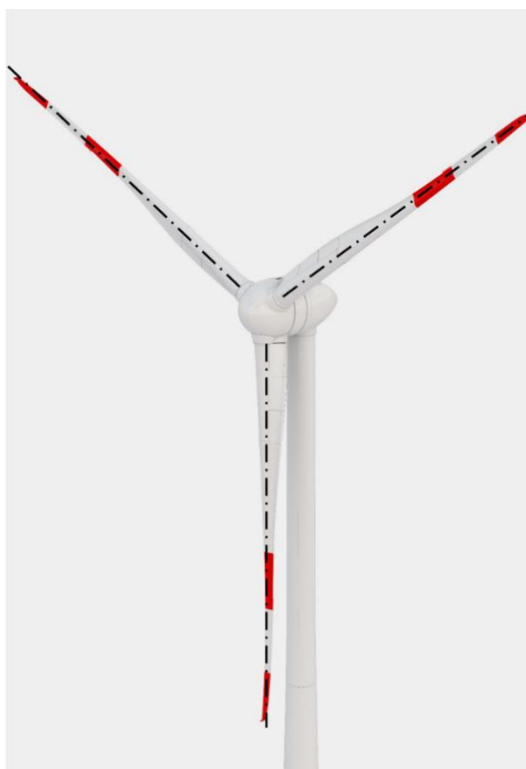
Figura 1. Eixos de rotação das pás em linha traço-ponto para controle do ângulo de arfagem.
