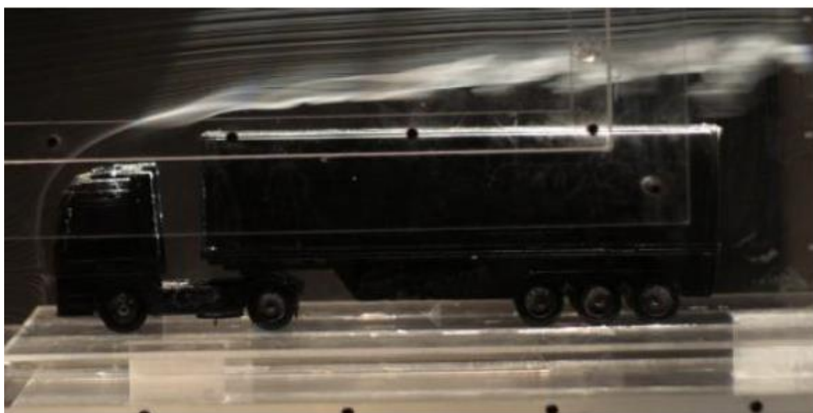
Figura 48 – Experimento com o modelo em escala 1/32 em túnel de vento
