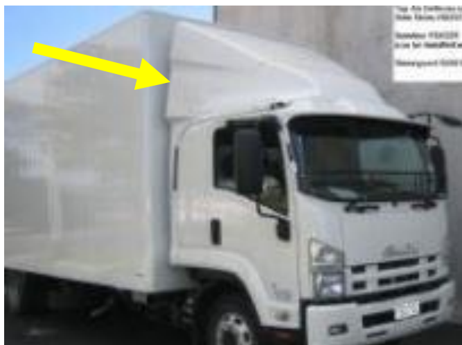
Figura 17 - Exemplo de aplicação dos defletores de teto
