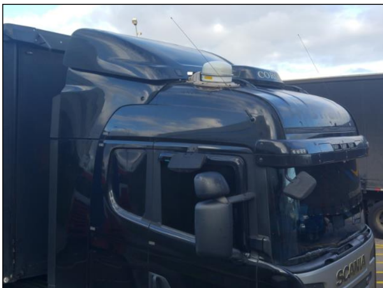
Figura 34 – Defletor de teto instalado em um Scania R440
