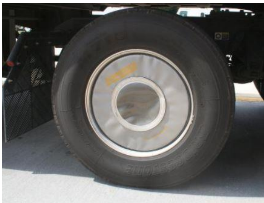
Figura 14 - Uso de calotas para melhorar o fluxo de ar pela roda
