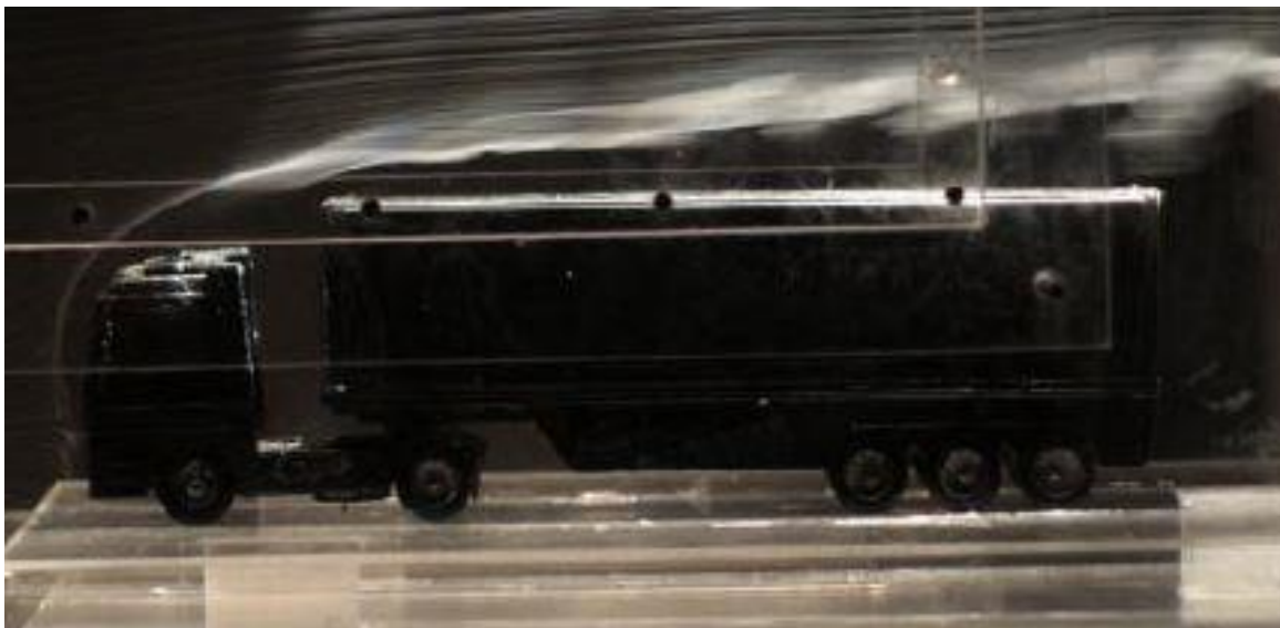
Figura 24 - Ensaio em túnel de vento, escala 1/32
