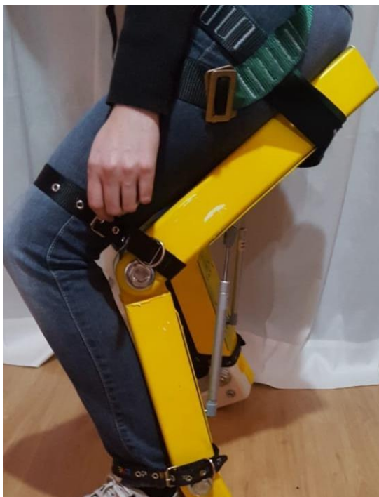
Figura 28 - Pistões de 140N com o exoesqueleto em uso
