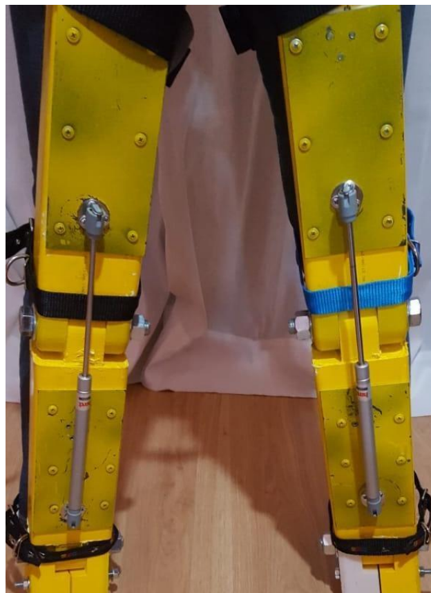
Figura 26 - Pistões acoplados ao exoesqueleto
