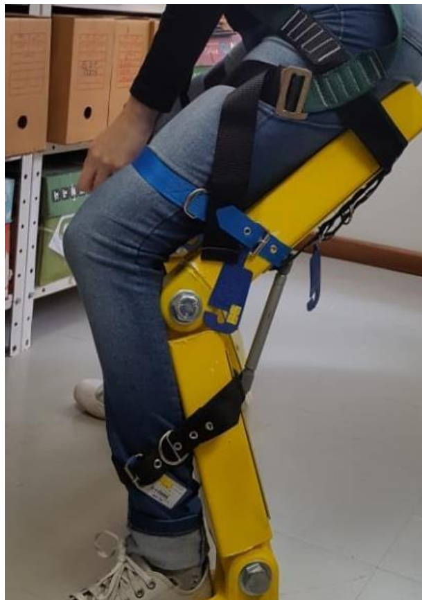
Figura 27 - Pistões de 100N com exoesqueleto em uso
