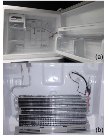
Figura 1 - Compartimento do congelador com a capa do evaporador no fundo (a) e evaporador exposto (b).
