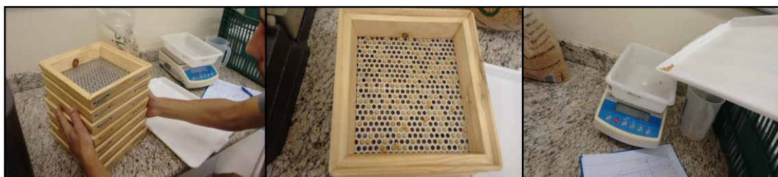
Figura 03: Etapas do processo do teste de retenção de peneiras; Fonte: O autor (2017).
