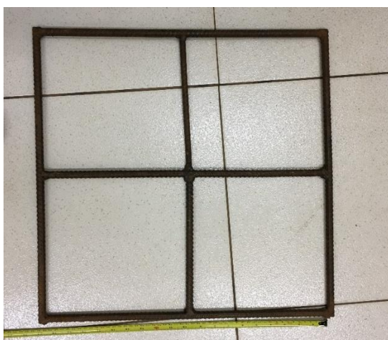
Figura 14 – Quadro metálico utilizado para o processo de amostragem à campo
