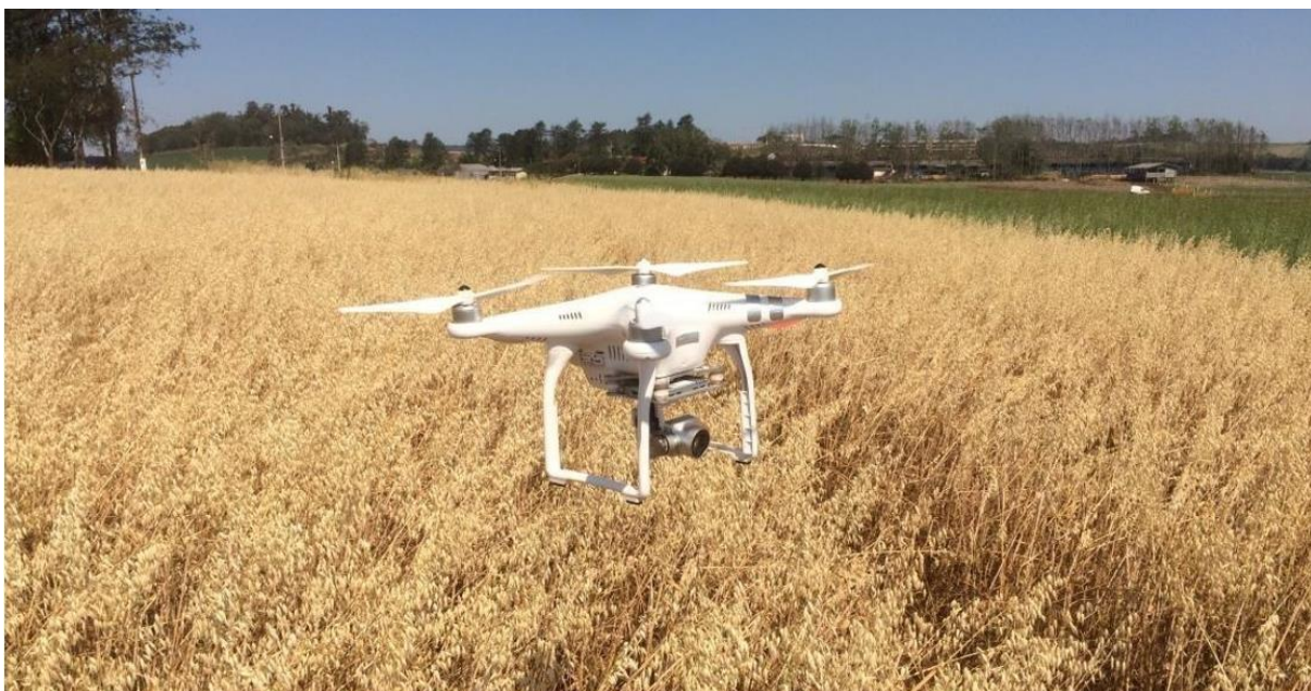
Figura 8 – RPAS utilizado para coleta de dados (Phantom 3 Advanced)
