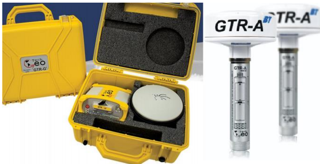
Figura 12 – Receptores GNSS utilizados na coleta de dados dos pontos de controle
