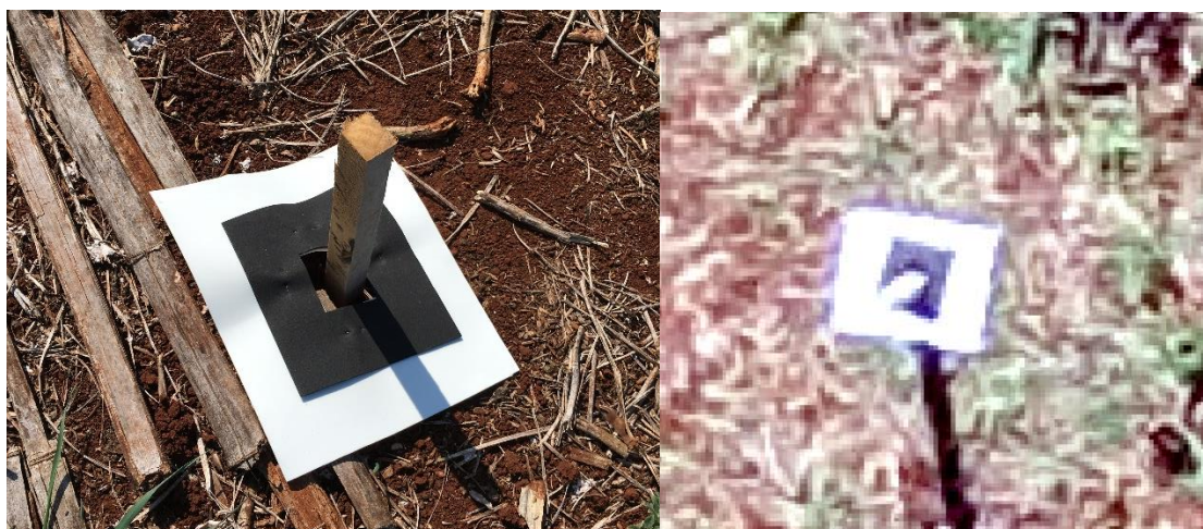
Figura 13 – Alvos utilizados para identificação dos pontos de controle
