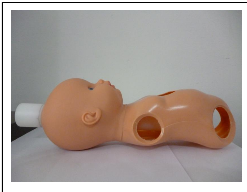
Figura 19 – Montagem interna do tubo de nylon no objeto simulador de um recém-nascido.
