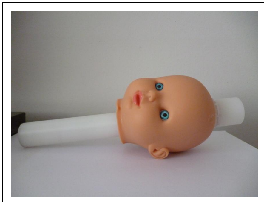
Figura 22 – Tubo de nylon fixado na cabeça do objeto simulador de um recém-nascido.
