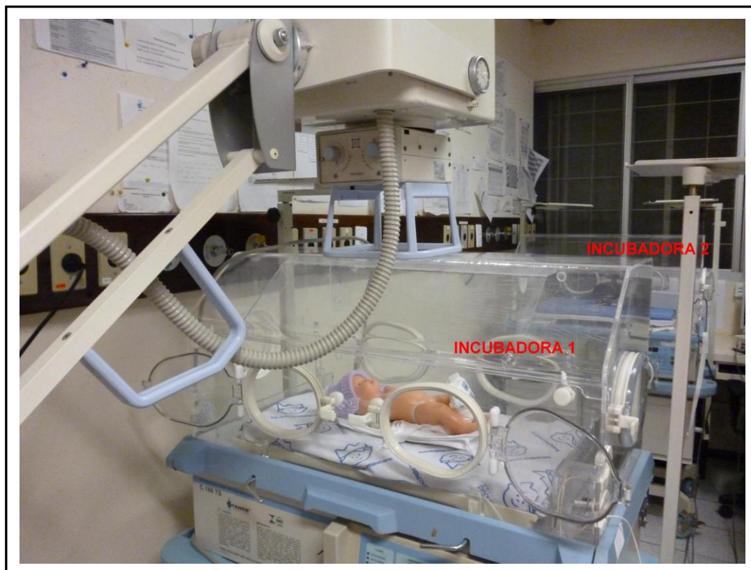
Figura 31 – Simulação da real disposição das incubadoras no setor, para avaliação da radiação espalhada na incubadora vizinha a do paciente submetido à radiografia torácica.
