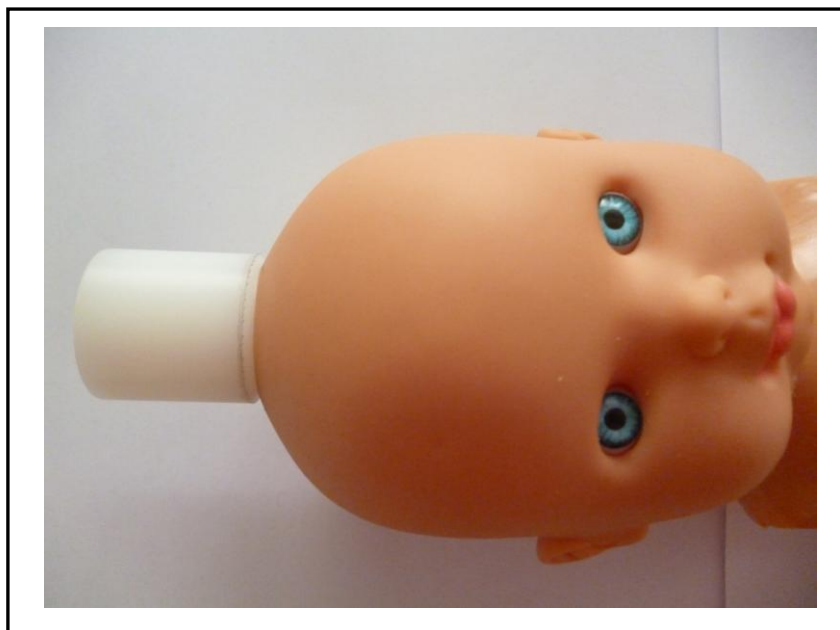
Figura 14– Tubo de proteção inserido no objeto simulador de um recém-nascido.
