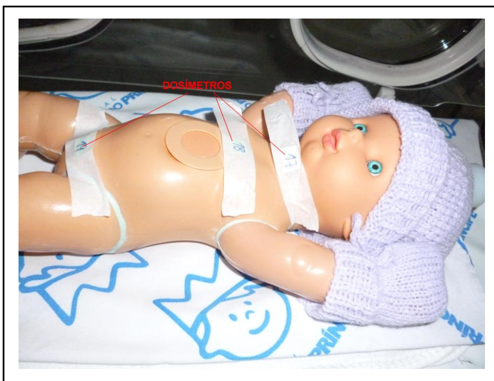
Figura 30 – Posicionamento dos TLDs no objeto simulador de um recém-nascido.
