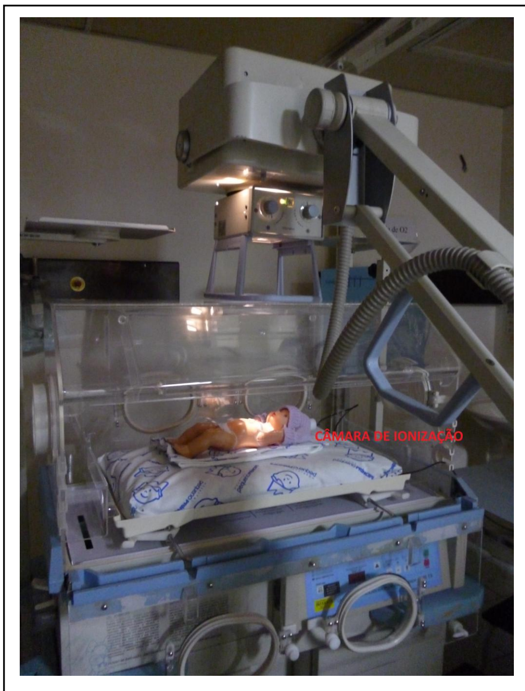
Figura 28 – Estrutura montada para parte do experimento – Simulação de exposições dentro da UTI neonatal.
