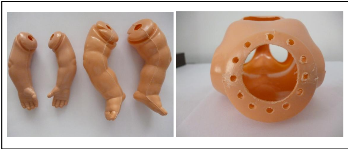
Figura 20 – Sequência de recorte realizada na montagem do objeto simulador.
