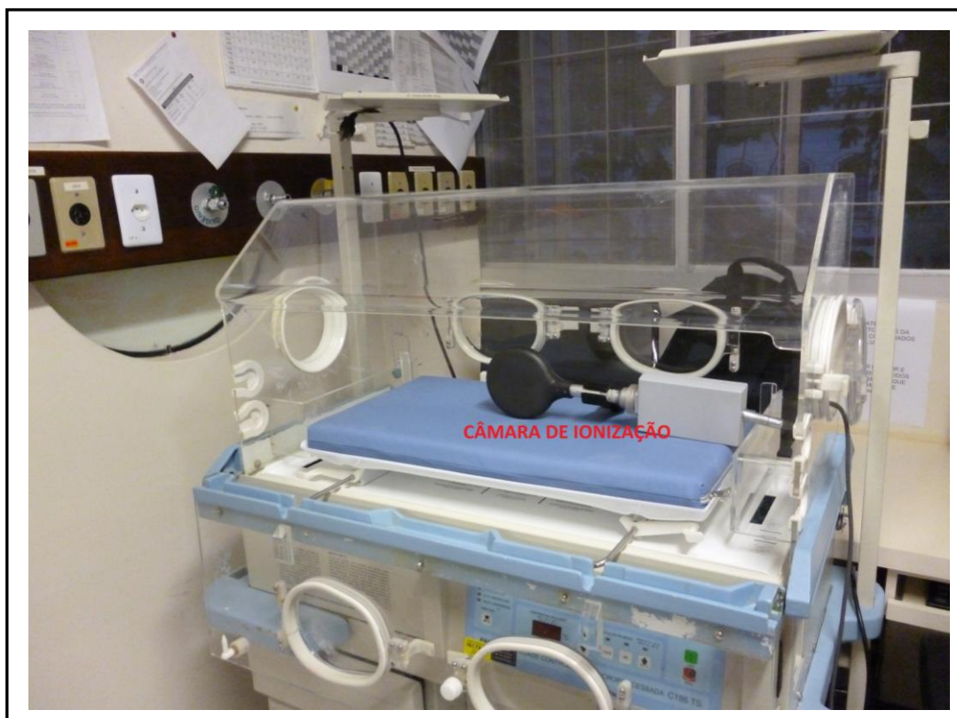
Figura 32 – Posicionamento da câmara de ionização para avaliação da radiação espalhada.
