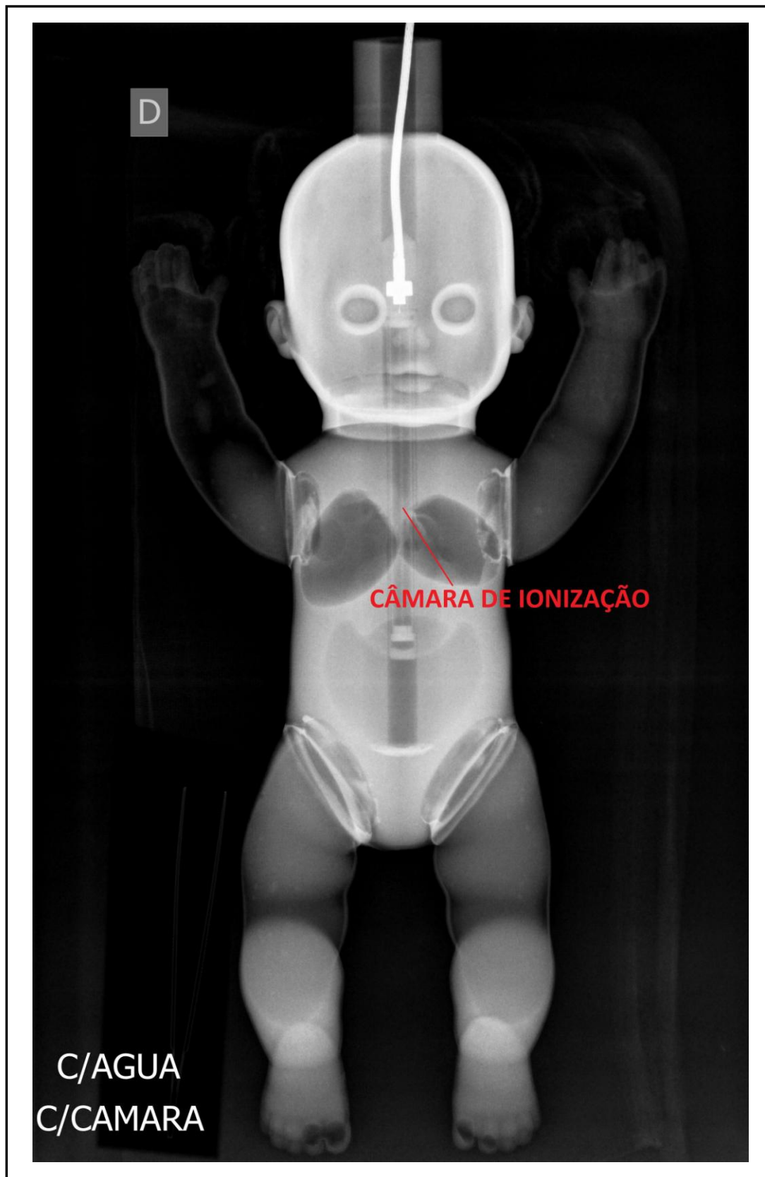
Figura 29 – Imagem radiográfica mostrando o posicionamento da câmara de ionização dentro do objeto simulador de um recém-nascido preenchido com água.
