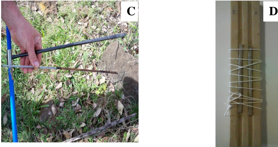
Figura 01: Demonstração da coleta das baquetas do lenho das árvores de louro-pardo e da fixação das mesmas no suporte de madeira A: Trado de Pressler; B: Coleta das amostras do lenho da árvore com o auxílio do trado de pressler; C: Retirada da amostra do lenho do louro-pardo; D: Amostras fixadas em suporte de madeira com cola e barbante.
