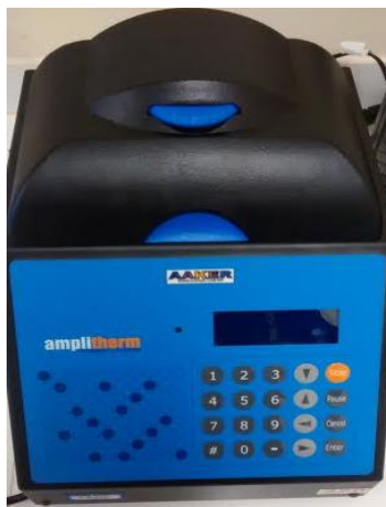
Figura 4 – Termociclador, utilizado para realização de desnaturação, pareamento e extensão do DNA, que ocorrem em temperaturas diferentes. Fonte: A autora (2015).
