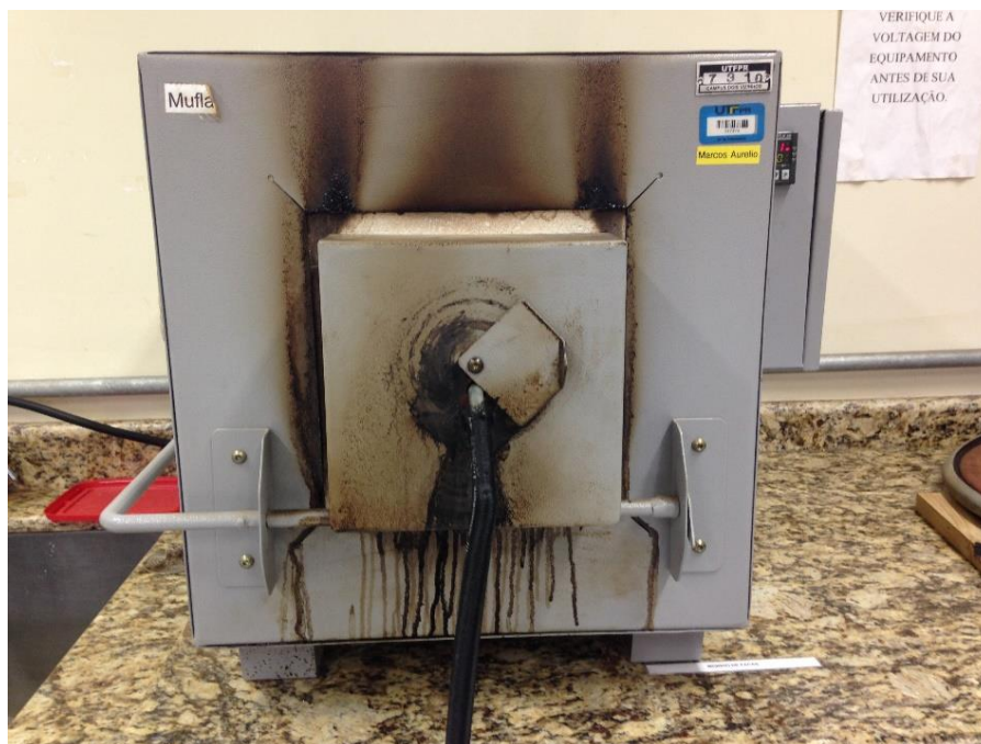
Figura 6 – Conexão do bico da cápsula na porta da mufla e mangueira captadora de fumaça.
