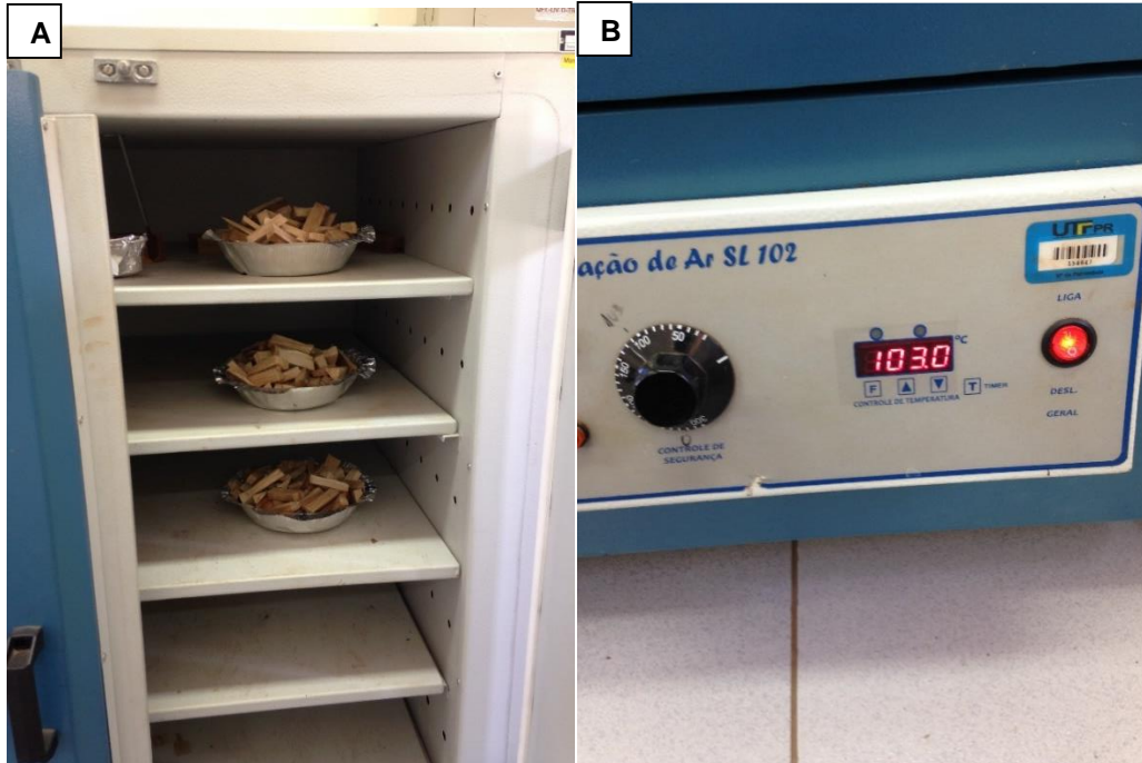
Figura 4 – Cavacos sendo secos em estufa (A) a 103 \pm 3^{\circ}\text{C} (B).
