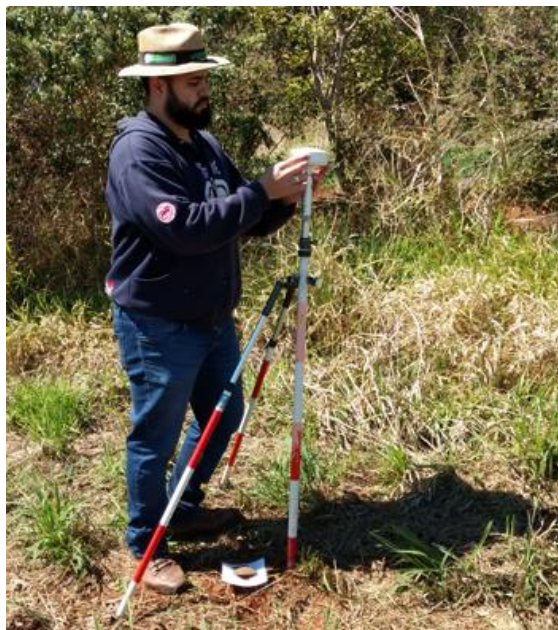
Figura 12: Posicionamento do equipamento GPS Topográfico rover.
