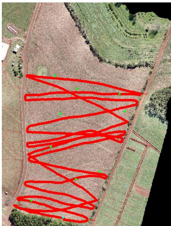
Figura 13: Distribuição de pontos obtidos pelo caminhamento com GNSS.
