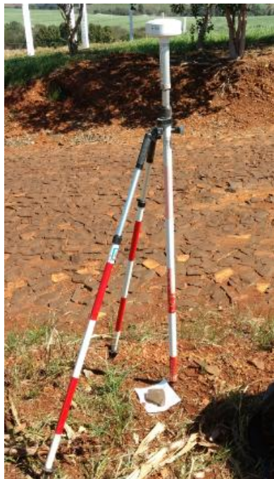
Figura 8: GPS topográfico instalado no campo.
