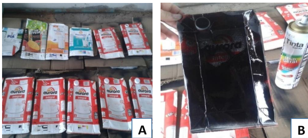
Figura 6 - Preparação do sistema de aquecimento de substrato por meio de caixas de leite higienizadas (A) e pintadas exteriormente com tinta preta (B). Fonte – Seidel, (2016).
